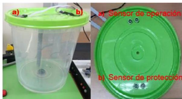
**Figura 48:** Tanque de agua utilizado para el prototipo: a) Sensor de operación, b) Sensor de protección.
