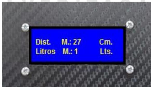
**Figura 49:** Pantalla LCD que muestra información básica de capacidad de tanque y distancia
