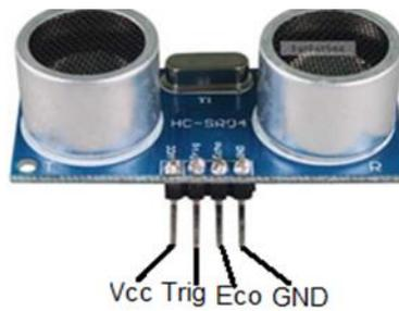
**Figura 26:** Configuración de pines del sensor ultrasónico HC-SR04.
