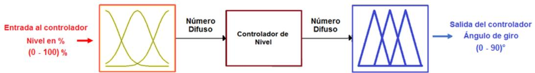
**Figura 37:** Entrada y salida del controlador difuso
