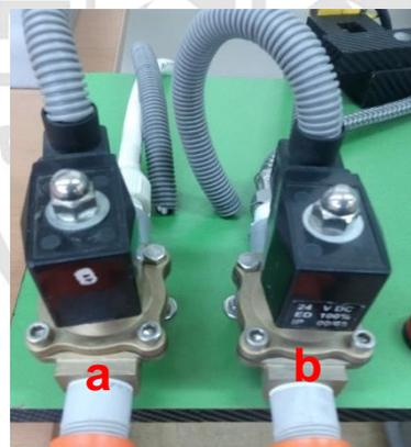
**Figura 52:** Electroválvulas: a) Salida de líquidos, b) Ingreso de líquidos
