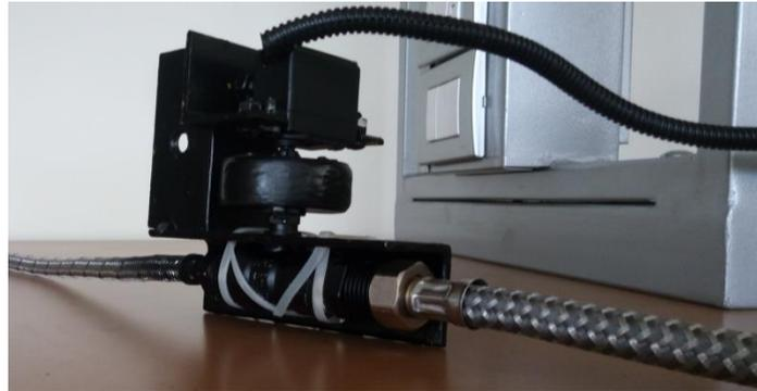
**Figura 50:** Servo válvula acondicionada para la apertura o restricción de líquido al tanque
