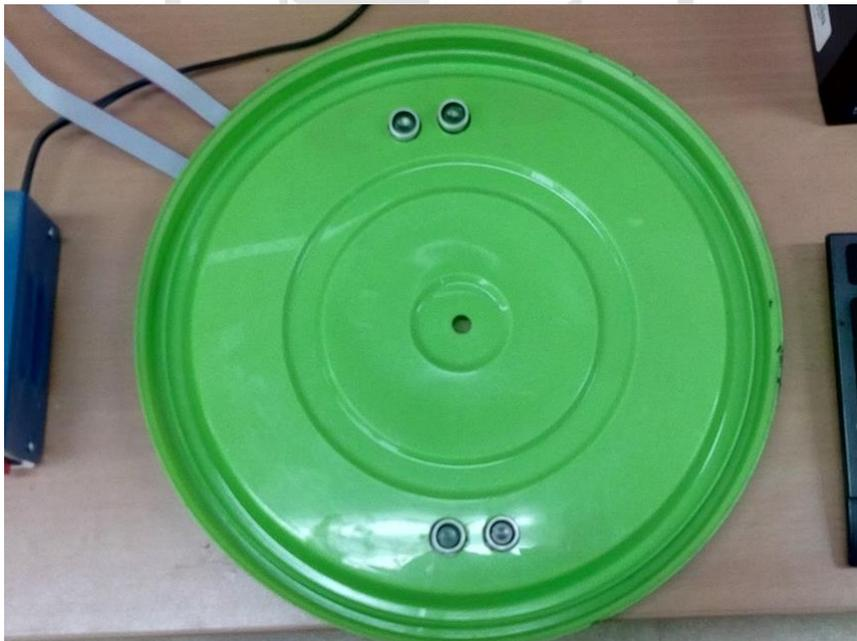
Sensores ultrasónicos acoplados a tapa de tanque prototipo
