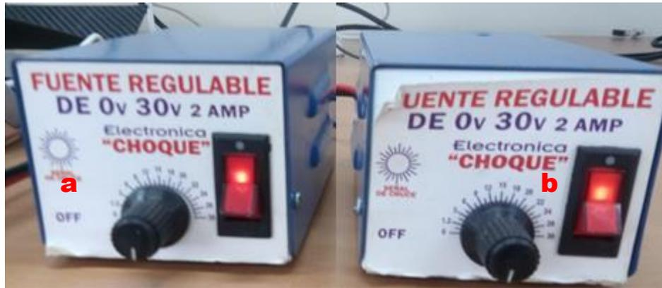
**Figura 53:** Fuentes de poder utilizadas en el prototipo: a) 24 V, b) 12 V
