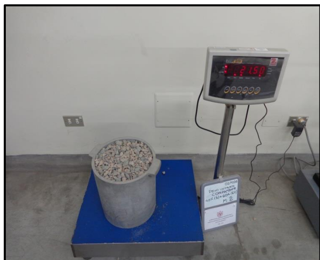
Foto 6: Hallando peso unitario suelto de combinación husos 5(40%) – 67 (60%). Muestra 2.
