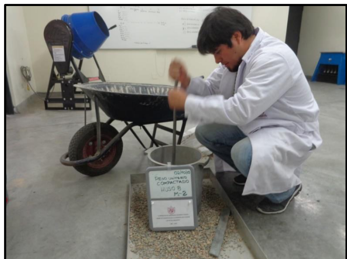
Foto 3: Hallando peso unitario compactado del huso 8.
