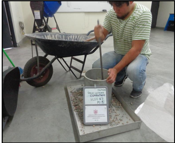
Foto 4: Hallando peso unitario compactado del huso 67.
