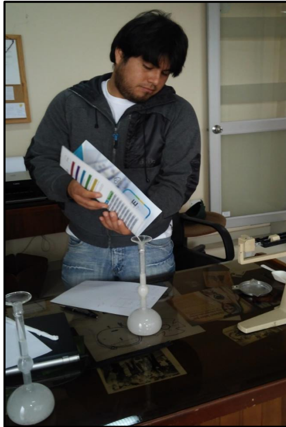
Foto 10: Hallando peso específico con el equipo Le Chetelier.
