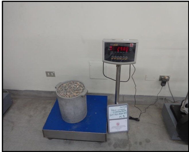
Foto 7: Hallando peso unitario suelto de combinación husos 5(50%) - 67 (50%). Muestra 1.
