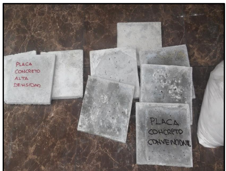
Foto 14: Placas 20 x 20 cm convencionales y de alta densidad.
