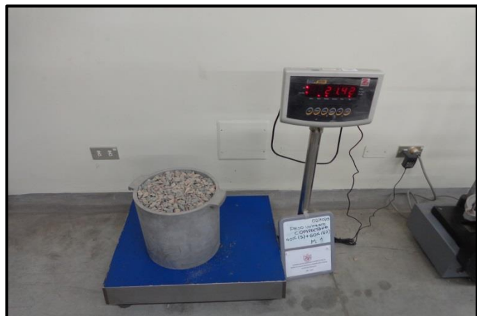
Foto 5: Hallando peso unitario suelto de combinación husos 5(40%) – 67 (60%) Muestra 1.
