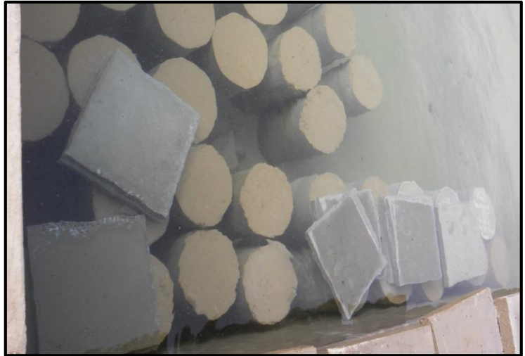
Foto 12.- Poza de curado de placas.
