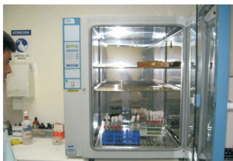
Figura 5.- Tubos conteniendo los medios, edulcorantes y microorganismos fueron llevados a una incubadora de CO2 por 48 horas
