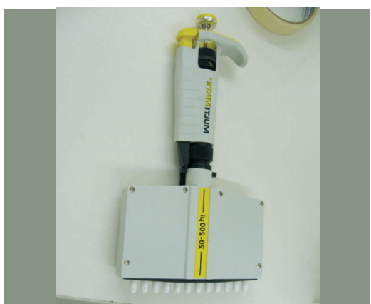
Figura 4.- Se utilizó una multipipeta para cargar las suspensiones de Streptococcus mutans y Lactobacillus Acidophilus
