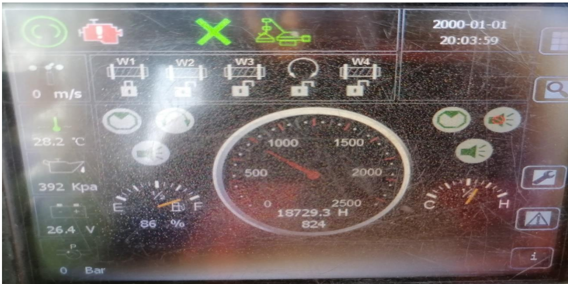
Figura 368. Pantalla del comando de grúa.
