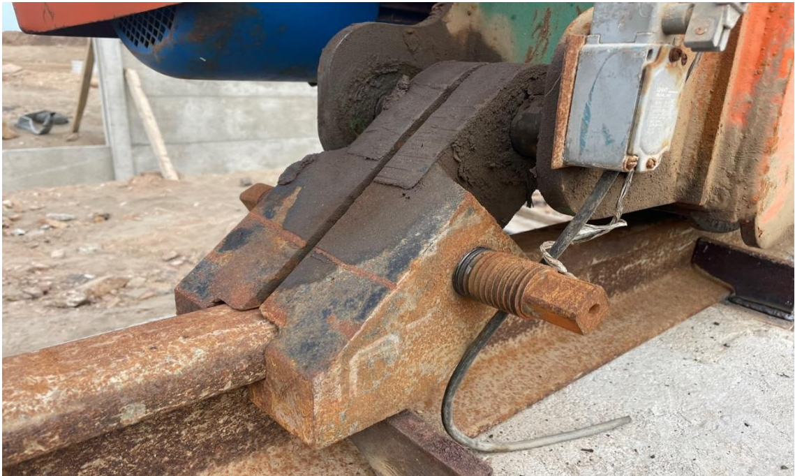
Figura 299. Abrazadera de riel bloqueada.
