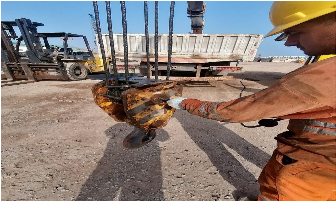
Figura 378. Puntos de engrase en el gancho.
