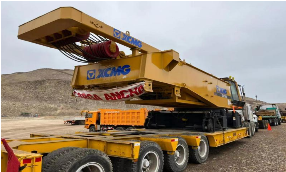
Figura 18. Camión Grua 50t.
