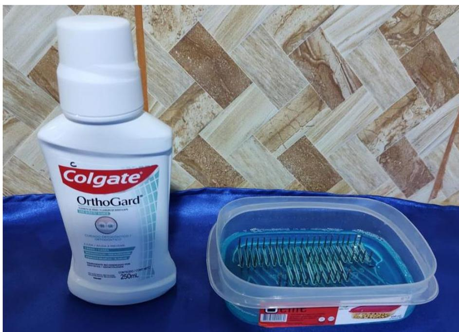
**Imagen N°7: Bases de acrílicos sumergidos en 300 ml de fluoruro de sodio al 0,04%**
