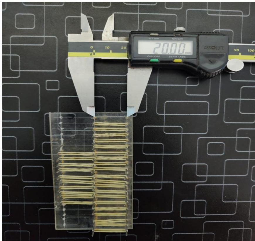
**Imagen N°4: Instrumento de medición y elásticos estirados a una distancia de 20 mm - VERNIER DIGITAL MARCA MITUTOYO**
