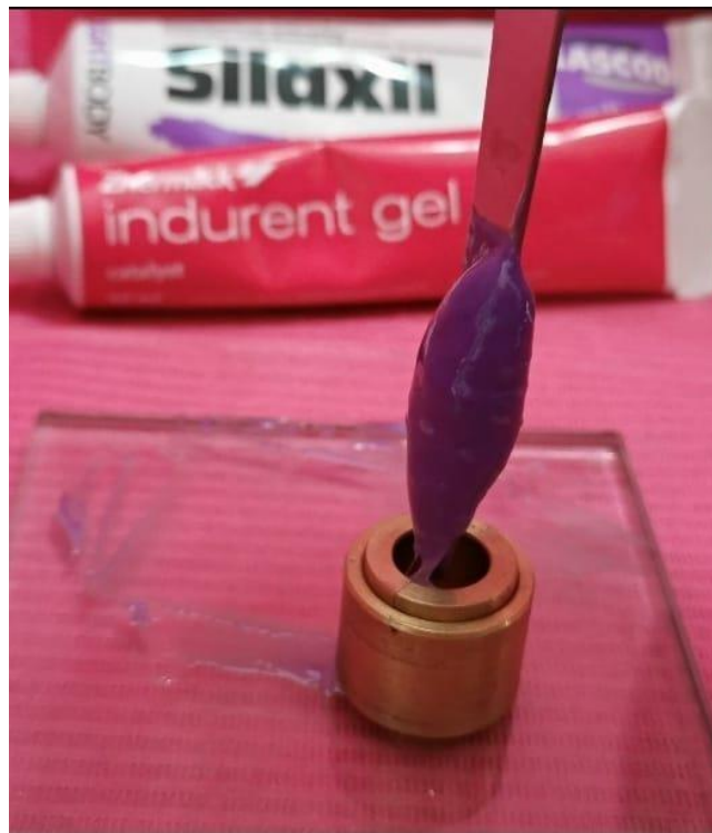
Figura 2.- mezclamos adecuadamente y colocamos la silicona de consistencia ligera en el molde A
