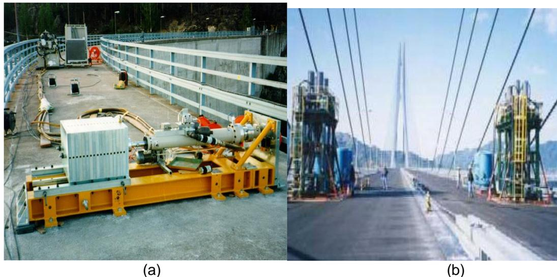
Nota: a) vibrador servo-hidráulico utilizado por EMA para excitar una presa en dirección horizontal. b) Vibradores utilizados en el puente atirantada de Tátara en Japón
