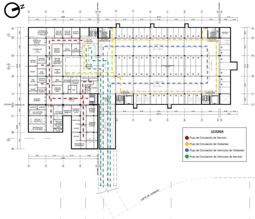
Figura 50: Flujo de Circulación del Sótano
