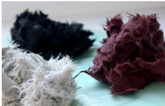
Figura 18. Compuesto de moldeo en masa en tres tonalidades. Tomado de Qué es BMC, por Astar, s.f.
