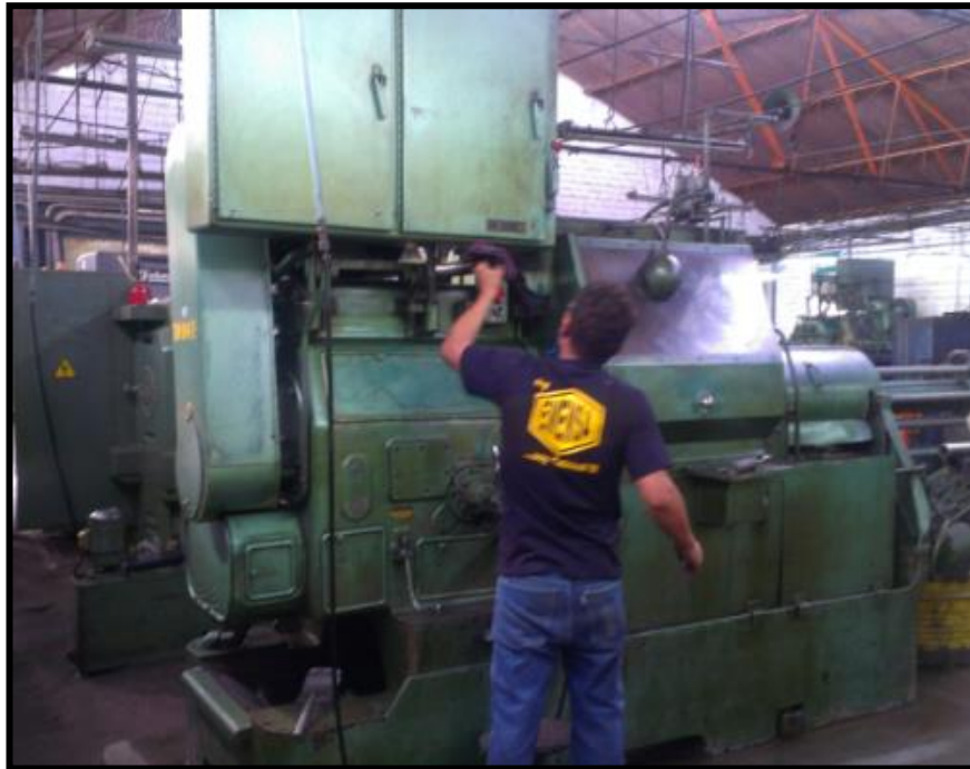
Figura: Limpieza de torno multihusillos Fuente: La Empresa
