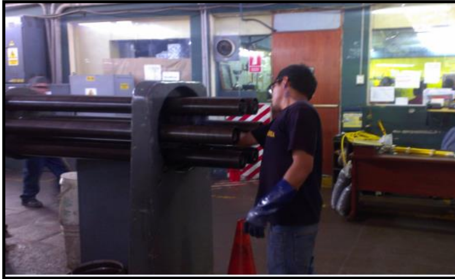
Figura: Limpieza de tubos de alimentación Fuente: La Empresa
