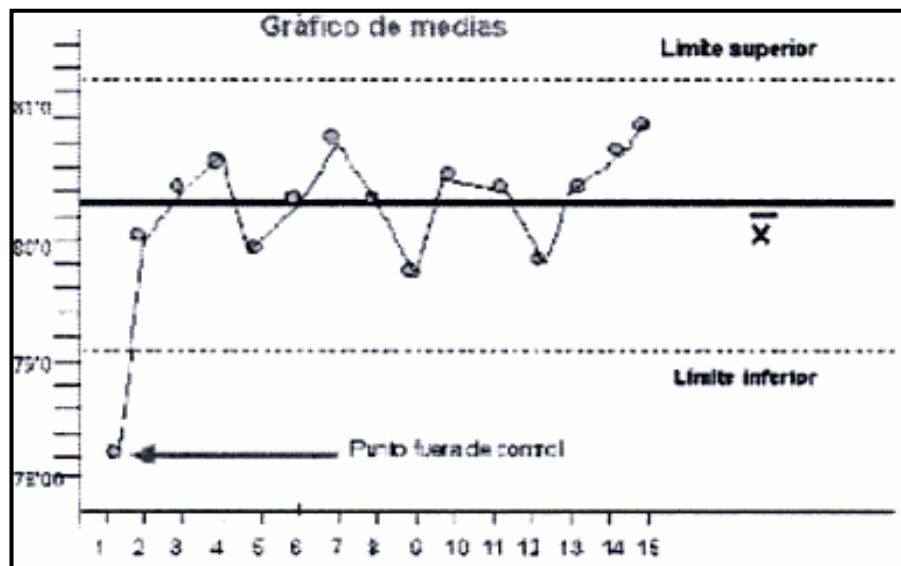
Figura 5: Gráfica de control Fuente: Los 7 Instrumentos de la Calidad Total
