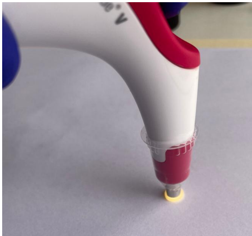
Figura N° 6 MEDICIÓN DE COLOR CON ESPECTROFOTÓMETRO EASY SHADE V
