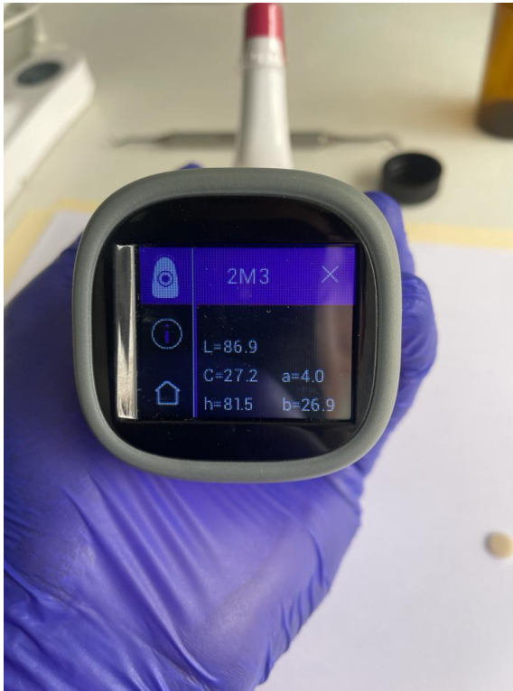
Figura N° 7 OBTENCIÓN DE DATOS DE ESPECTROFOTÓMETRO EASY SHADE
