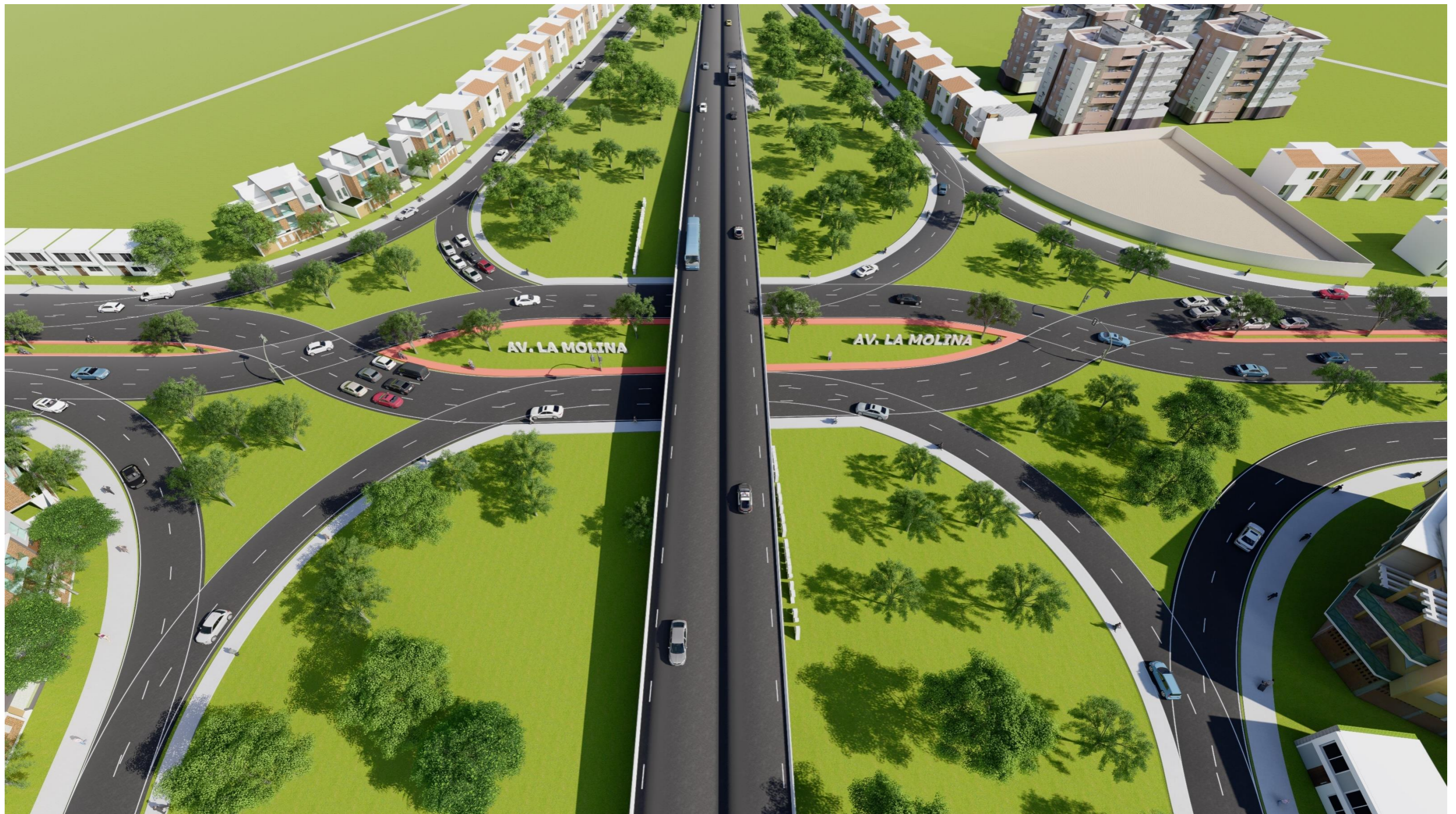
Propuesta Vial N°2 (Ganadora): Intercambio Diamante Divergente ubicado en la Intersección de la Av. Javier Prado con Av. La Molina
