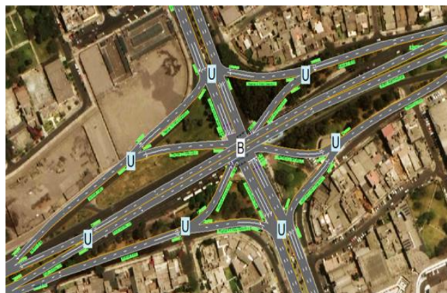
3.2. Intercambio Urbano de Punto Único situado en la Intersección de la Av. Javier Prado con Av. La Molina
