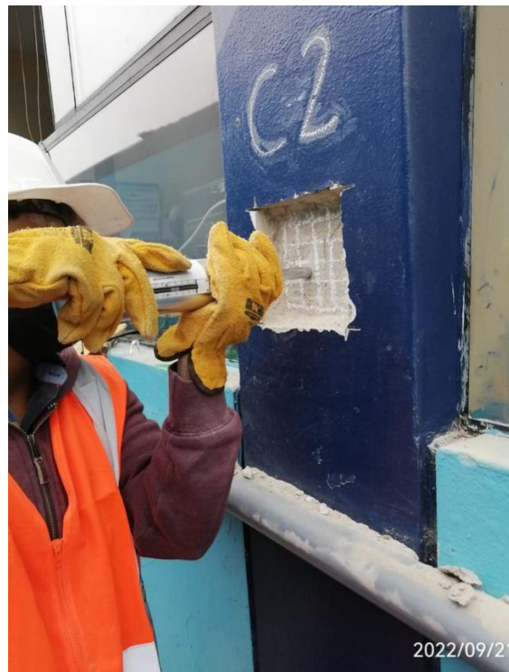
Ensayo de esclerometría en la Columna 3 – Pabellón B
