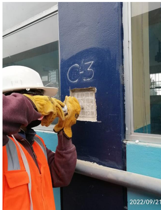
Ensayo de esclerometría en la Columna 3 – Pabellón B
