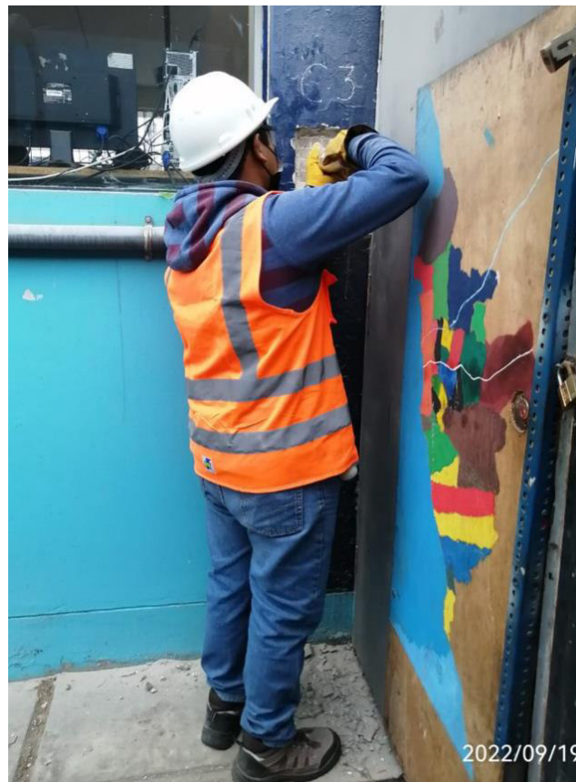
Ensayo de esclerometría en la Columna 1 – Pabellón B
