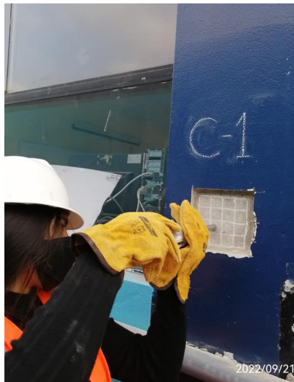
Ensayo de esclerometría en la Columna 1 – Pabellón B
