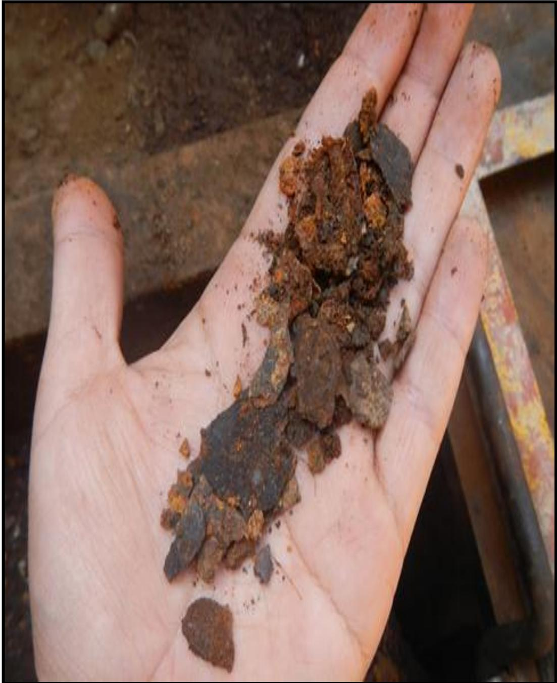
**Gráfico N° 16.** Restos de tubería degradada.
