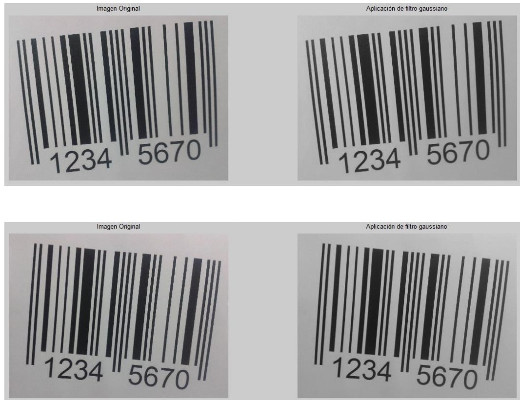
Figura (38) Comparación de las imágenes de código de barras antes y después de aplicar el filtro gaussiano con \sigma = 1 tomadas de noche en presencia de luz artificial color blanco.
