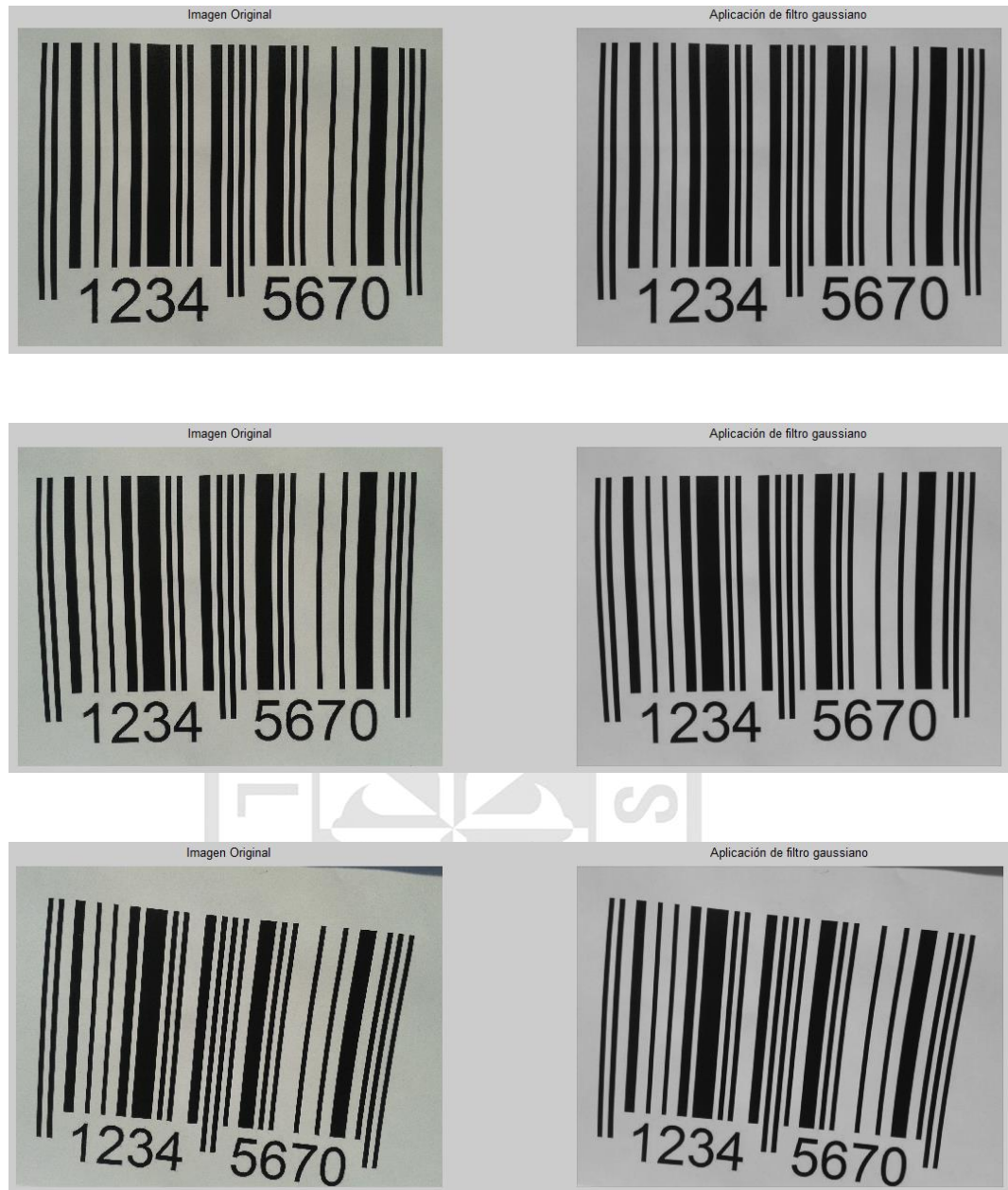
Figura (39) Comparación de las imágenes de código de barras antes y después de aplicar el filtro gaussiano con \sigma = 3 tomadas en el exterior.
