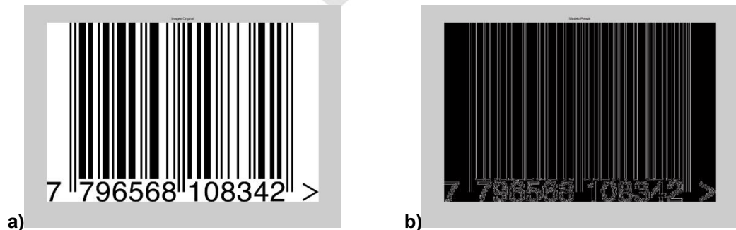
Figura (9) Detección de bordes de imagen de código de barras mediante el operador de Prewitt. (9.a) Imagen original. (9.b) Aplicación del operador de Prewitt.
