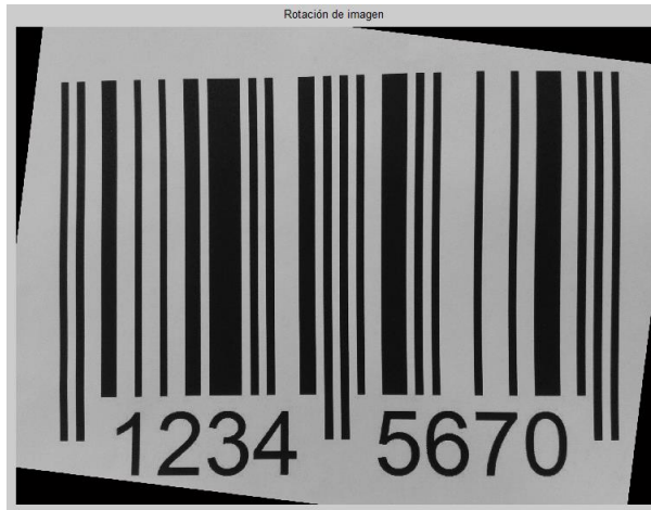
Figura (62) Imagen original de código de barras rotada mediante la transformada de Hough.
