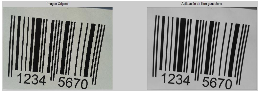
Figura (42) Comparación de las imágenes de código de barras antes y después de aplicar el filtro gaussiano con \sigma = 5 tomadas en el exterior.
