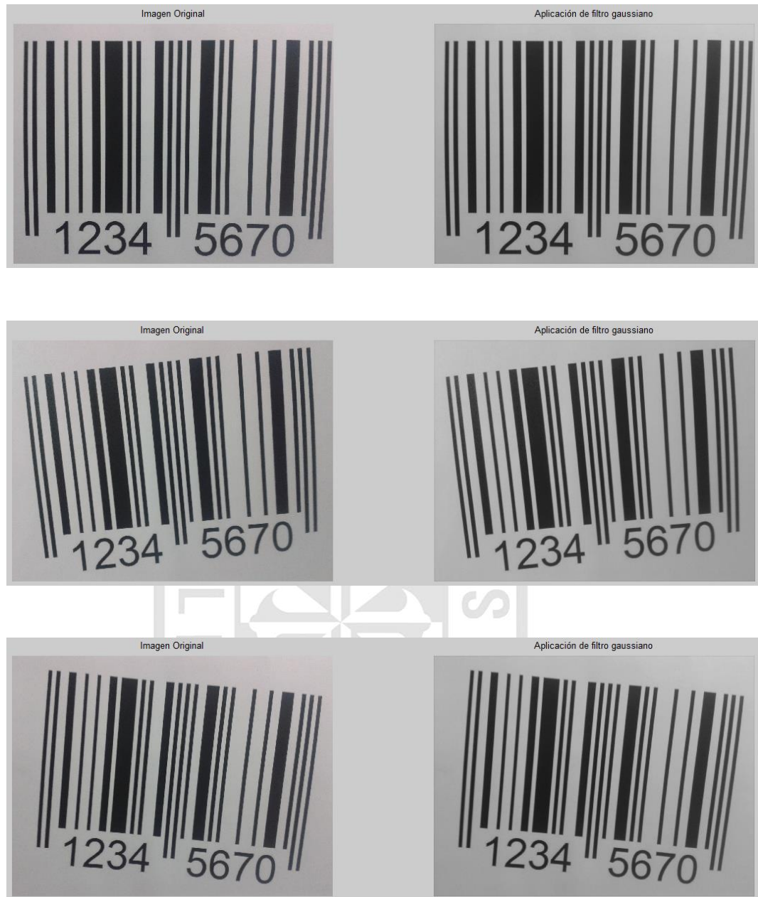
Figura (41) Comparación de las imágenes de código de barras antes y después de aplicar el filtro gaussiano con \sigma = 3 tomadas de noche en presencia de luz artificial color blanco.
