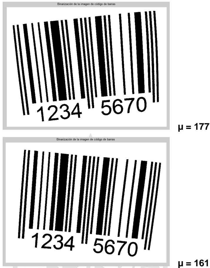
Figura (69) Imágenes de código de barras binarizadas por el método basado en la forma del histograma.
