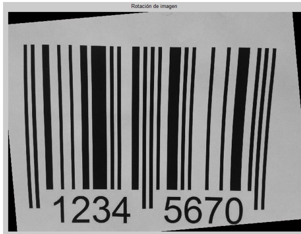
Figura (63) Imágenes de código de barras rotadas mediante la transformada de Hough tomadas en el exterior.
