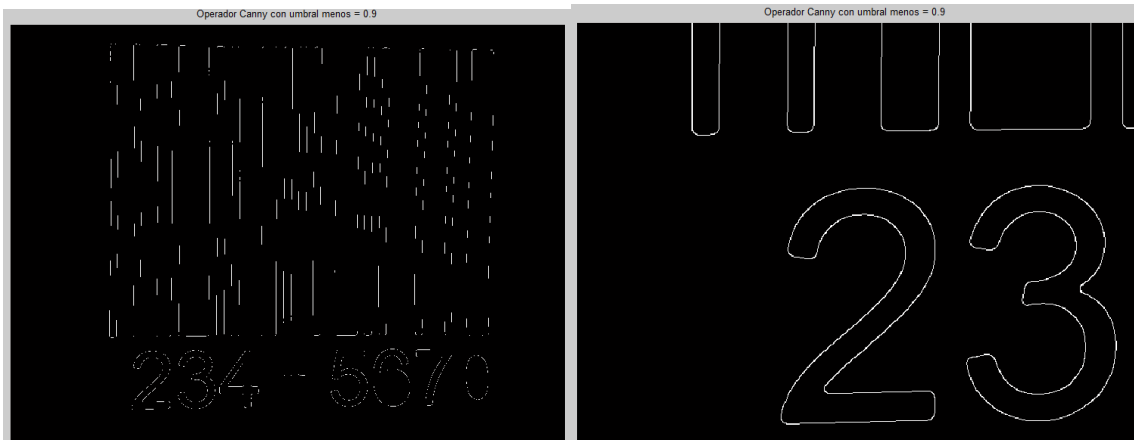
Figura (56) Detección de bordes mediante el operador de Canny con un umbral de \mu = 0.9 . (66.a) Operador de Canny aplicado a la imagen de código de barras (66.b) Acercamiento de la imagen para apreciar los resultados en los bordes.
