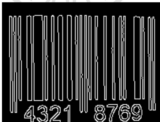
Figura (92) Detección de bordes de la imagen de código de barras mediante el operador de Canny.
