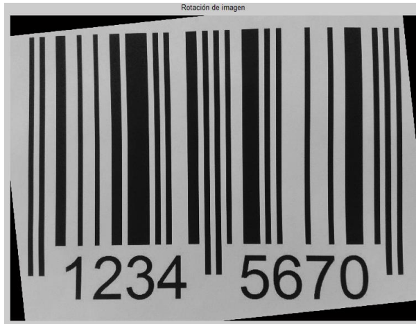
Figura (64) Imágenes de código de barras rotadas mediante la transformada de Hough tomadas en un ambiente bajo techo.
