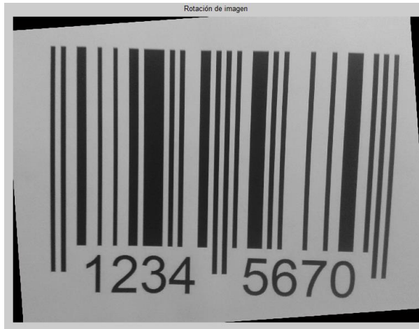
Figura (65) Imágenes de código de barras rotadas mediante la transformada de Hough tomadas de noche en presencia de luz artificial color blanco.
