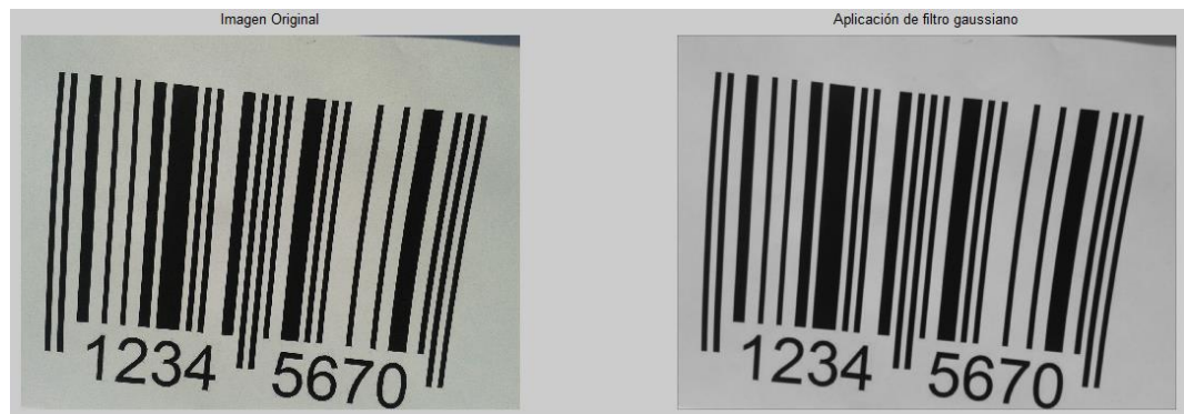
Figura (45) Comparación de las imágenes de código de barras antes y después de aplicar el filtro gaussiano con \sigma = 7 tomadas en el exterior.
