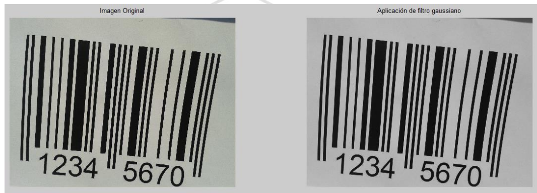
Figura (36) Comparación de las imágenes de código de barras antes y después de aplicar el filtro gaussiano con \sigma = 1 tomadas en el exterior.
