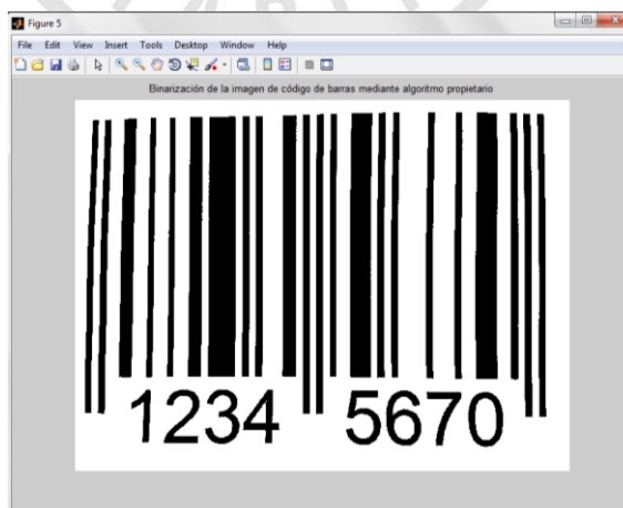
Figura (78) Binarización de la imagen de código de barras mediante el método basado en la forma del histograma.
