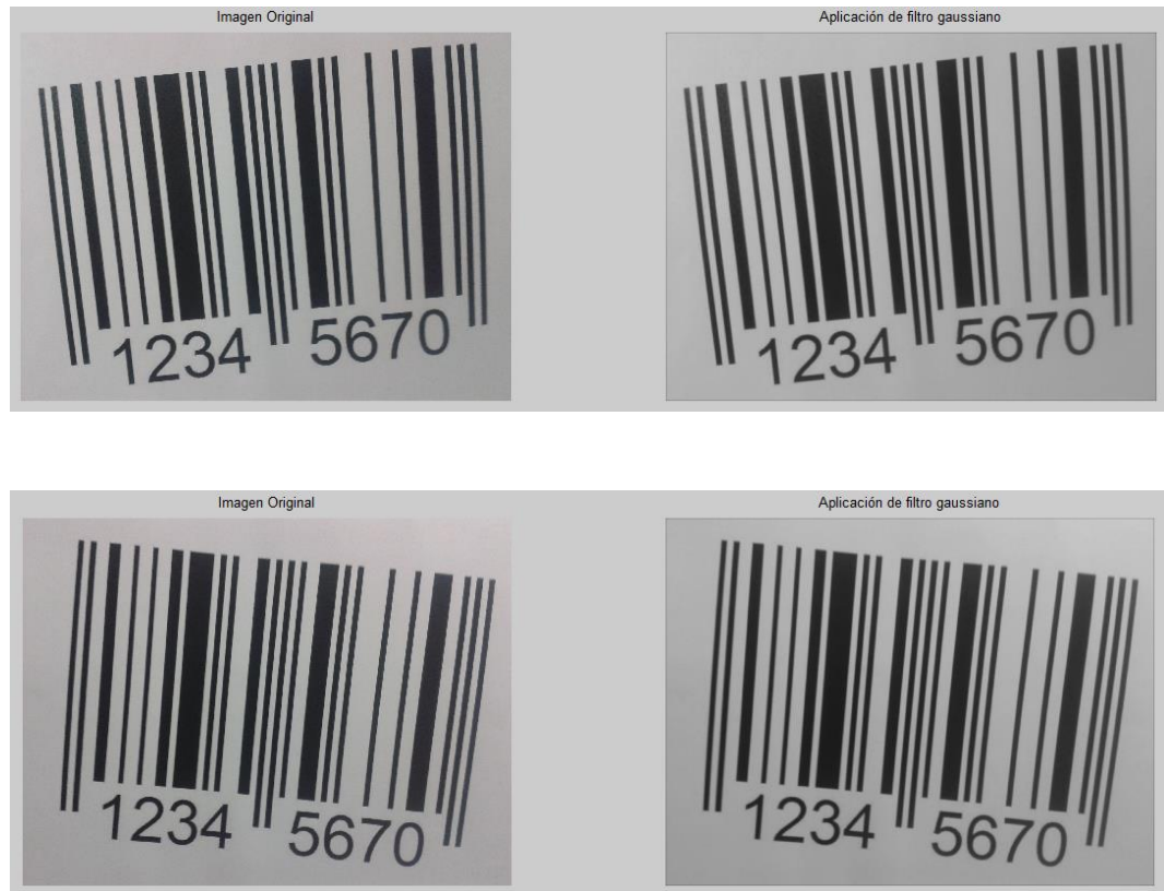
Figura (47) Comparación de las imágenes de código de barras antes y después de aplicar el filtro gaussiano con \sigma = 7 tomadas de noche en presencia de luz artificial color blanco. Elaboración: Los autores.
