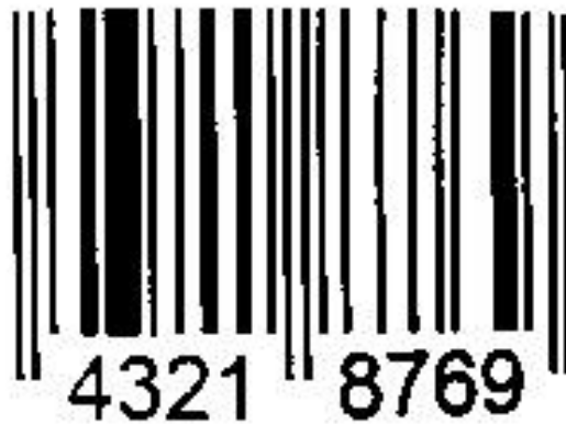
Figura (95) Binarización de la imagen de código de barras mediante el método basado en la forma del histograma.
