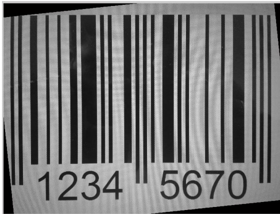
Figura (30) Imagen de código de barras en escala de grises capturada con la cámara del dispositivo móvil. Elaboración: Los autores.
