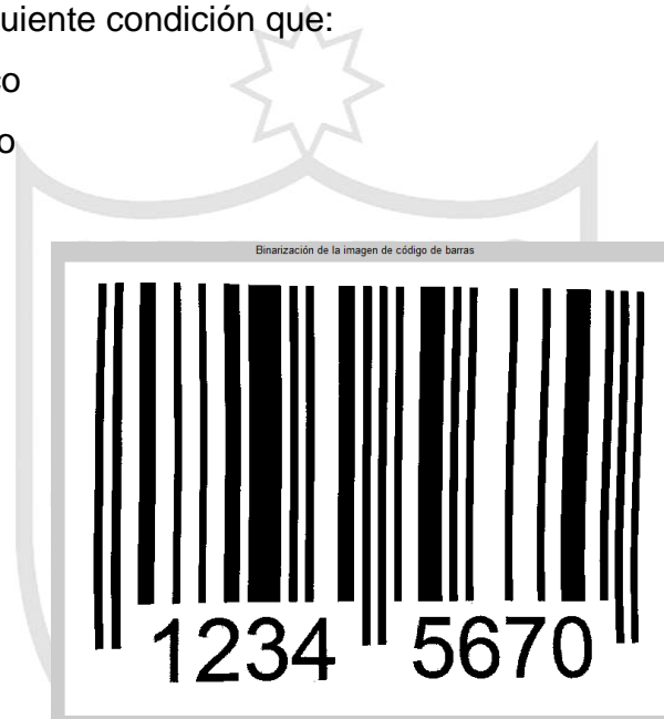
Figura (68) Imagen de código de barras binarizada mediante el método basado en la forma del histograma.
