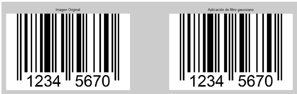
Figura (19) Resultado de la aplicación del filtro gaussiano en la imagen de código de barras.
