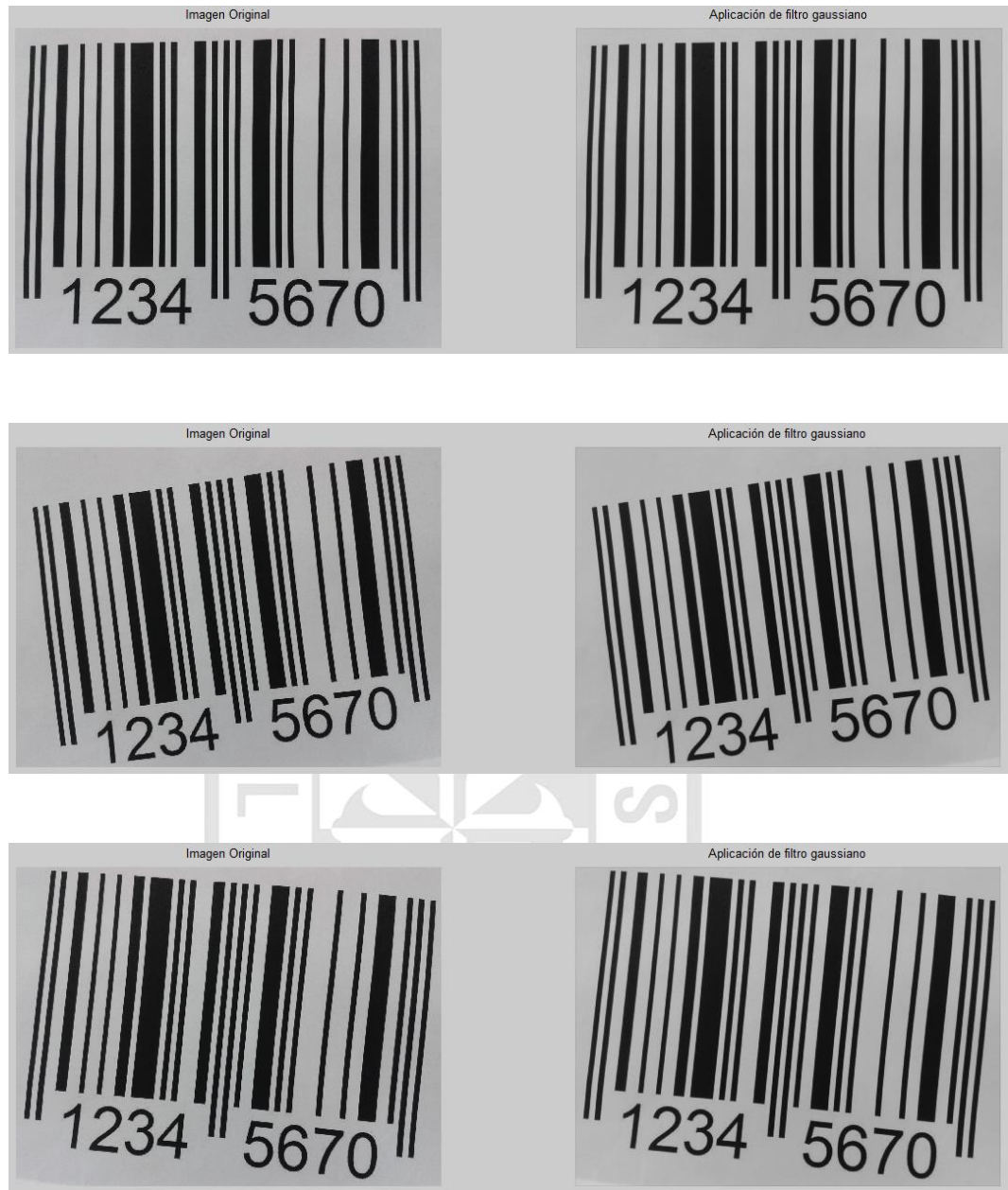
Figura (40) Comparación de las imágenes de código de barras antes y después de aplicar el filtro gaussiano con \sigma = 3 tomadas bajo techo.
