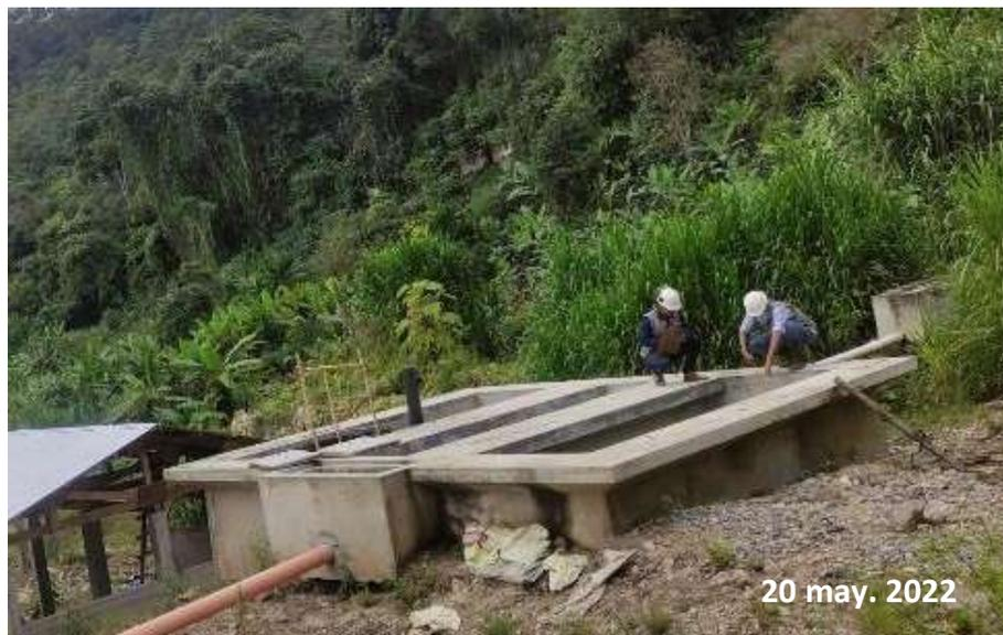
*Nota:* Se observa la primera medición del nivel de agua del tanque Imhoff en la prueba de estanqueidad.
