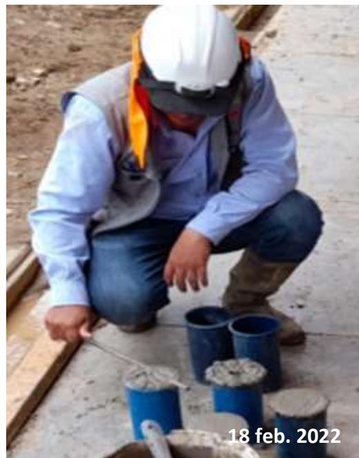
*Nota:* Esta figura muestra el enrasado de material excedente en los testigos cilíndricos.
