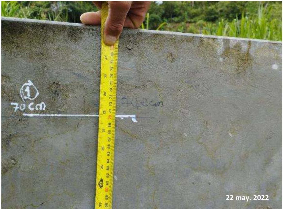
*Nota:* Esta figura muestra la segunda medición del nivel de agua del tanque Imhoff después de un lapso de 48 horas durante la prueba de estanqueidad, se tomo como segunda lectura 70.2 cm.
