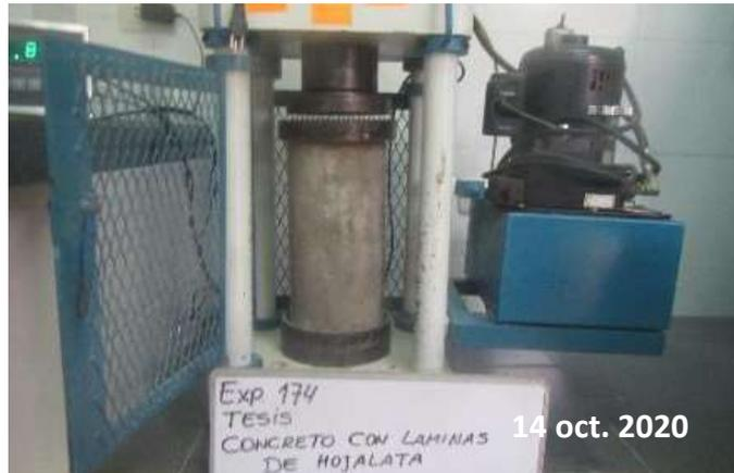
*Nota:* La figura muestra el equipo durante el ensayo de compresión.
