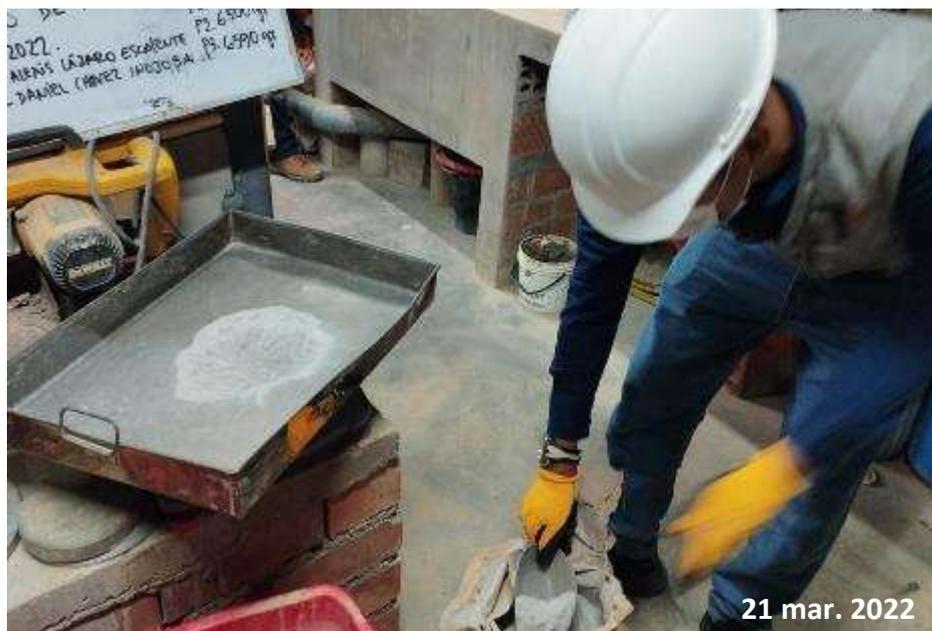
Nota: Esta figura muestra el proceso de pesado de la muestra Sikalastic - 1K.
