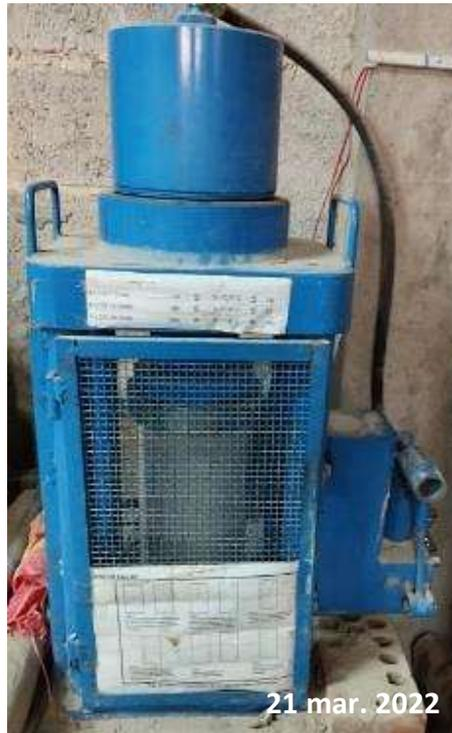
*Nota:* Esta figura muestra el equipo para la realización del ensayo a compresión.
