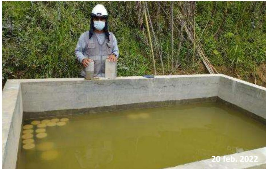
*Nota:* Esta figura muestra el proceso de colocacion de las muestras en una poza de agua para el proceso de curado.
