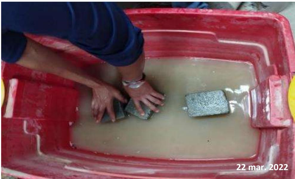
*Nota:* Se observa la extracción de los testigos sumergidos en agua para obtener el peso húmedo.
