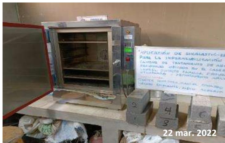
*Nota:* Esta figura muestra los testigos que serán ingresados al horno por 24 horas a 110 °C .
