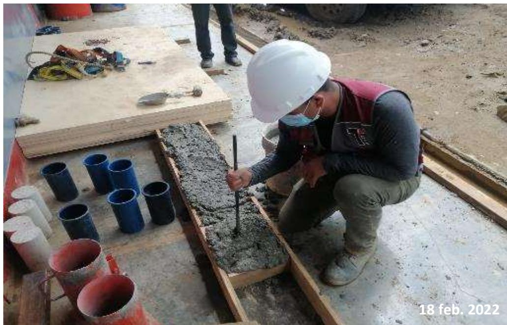
*Nota:* Esta figura muestra el vaciado en las probetas rectangulares con dimensiones 24cm x 13cm x 10cm.
