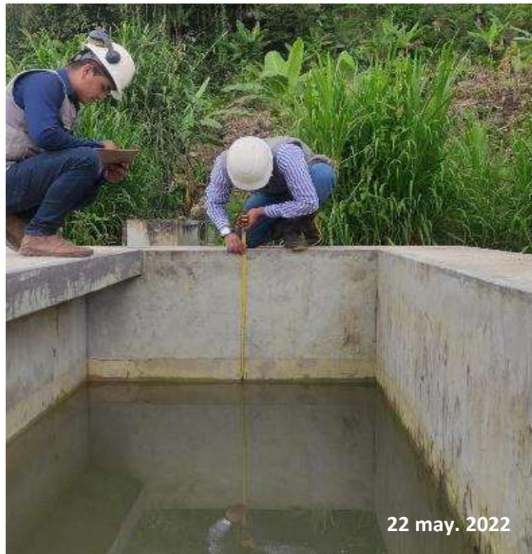
*Nota:* Esta figura muestra la segunda medición del nivel de agua en la cámara de ventilación.
