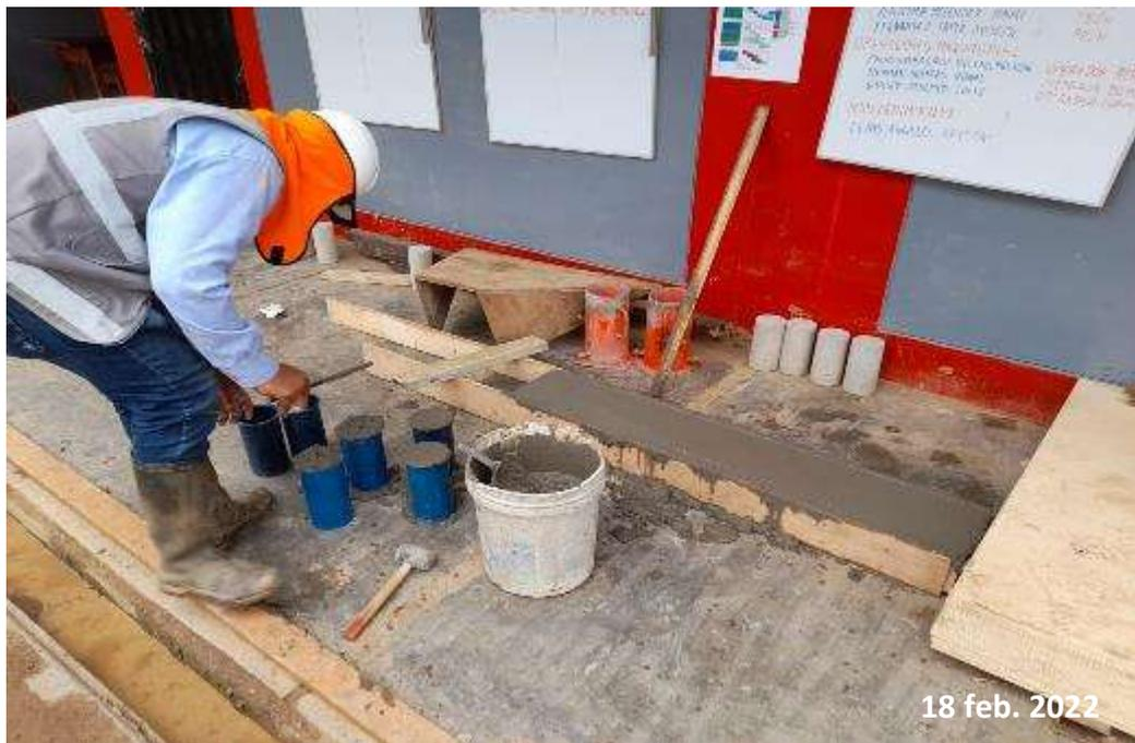
*Nota:* Esta figura muestra el vaciado en las probetas cilíndricas y rectangulares.
