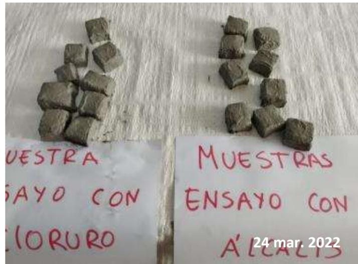
*Nota:* Se muestran los morteros revestidos con Sikalastic – 1K para realizar los ensayos de resistencia.
