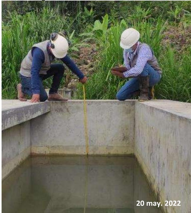
*Nota:* Se aprecia en la figura 160 la medición del nivel de agua en la cámara de ventilación.
