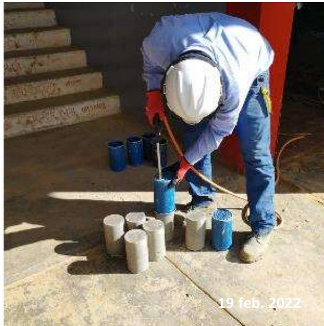
*Nota:* Esta figura muestra el desmoldaje de las probetas cilíndricas con la ayuda de una pistola de aire a presión.
