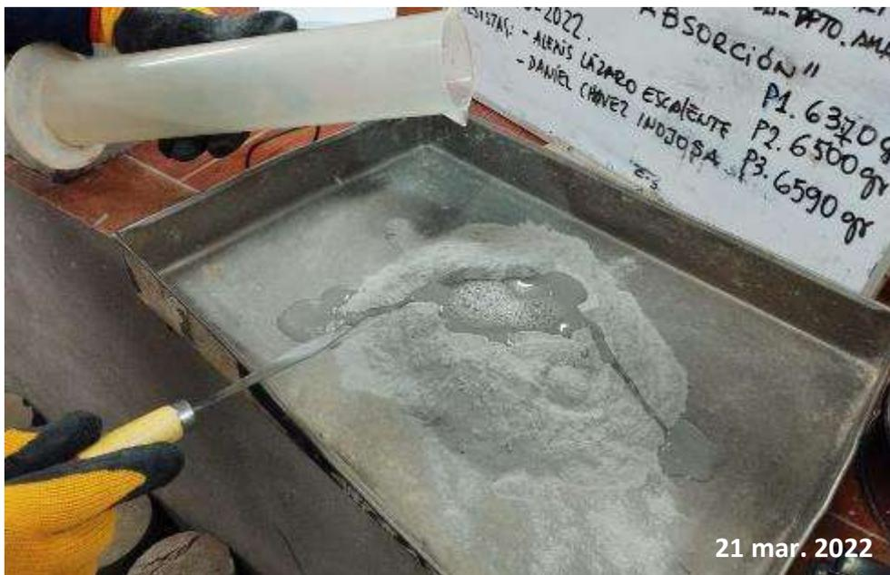
*Nota:* Se observa en la figura 97 el proceso de mezcldo del Sikalastic - 1K.
