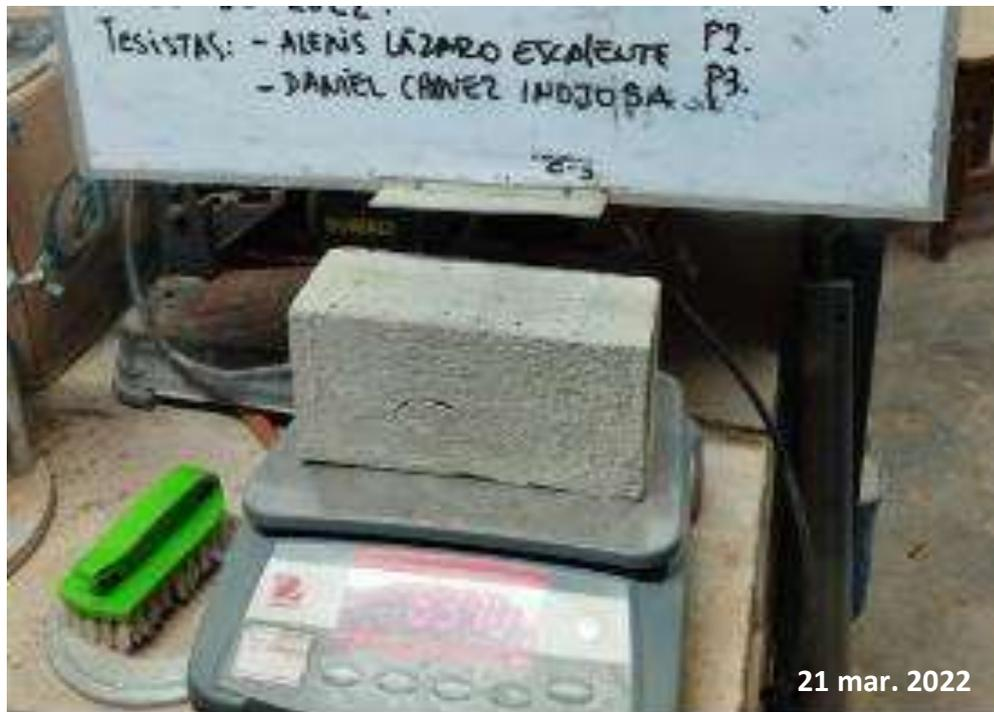
*Nota:* Esta figura muestra el pesaje de los testigos del concreto patrón.
