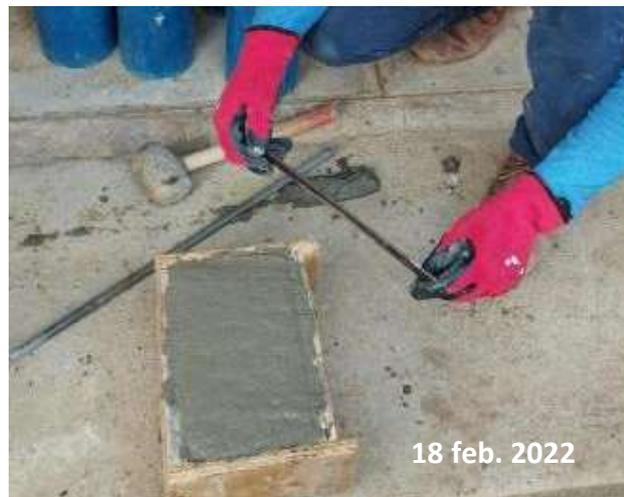
*Nota:* Esta figura muestra el enrasado y nivelación de los testigos rectangulares.
