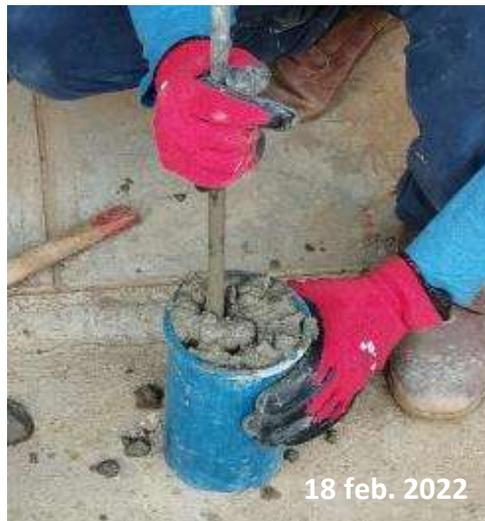
*Nota:* Esta figura muestra los 25 golpes en espiral por capa con una varilla lisa de 12 mm.
