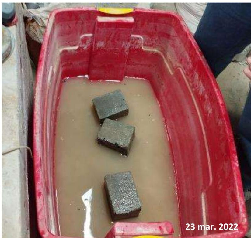
*Nota:* Esta figura muestra los testigos con fisuras sumergidas en agua durante 24 horas.
