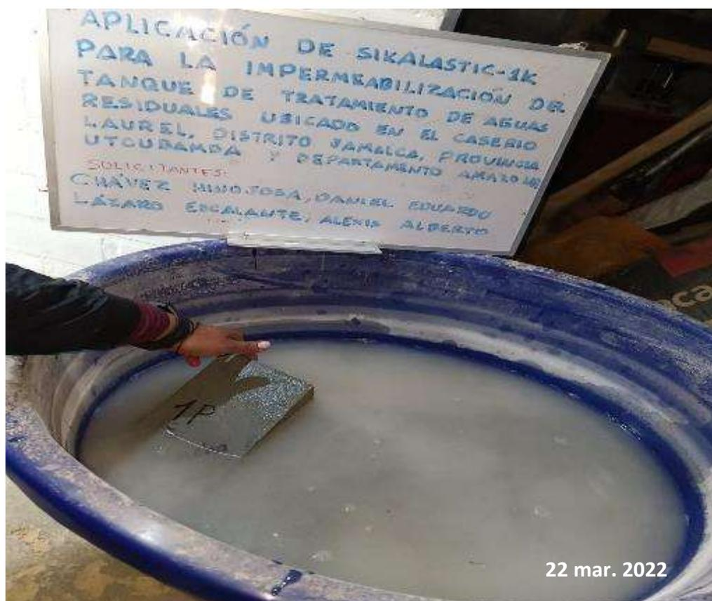
*Nota:* Esta figura muestra los testigos con la aplicación del Sikalastic – 1K sumergidas en agua por 24 horas .
