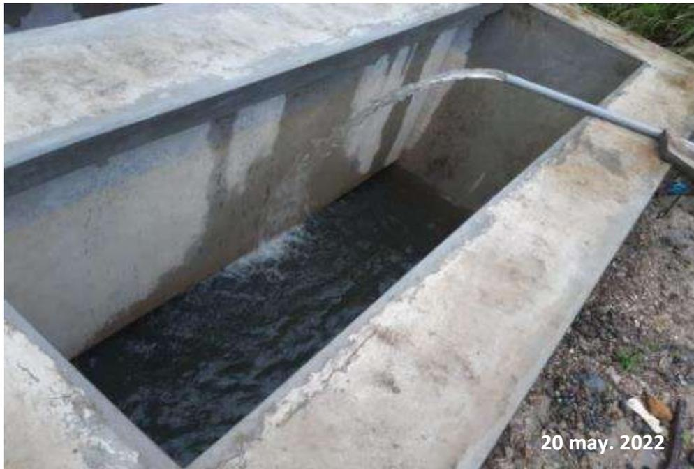
Nota: Esta figura muestra el llenado del tanque Imhoff para la realización de la segunda prueba hidráulica.
