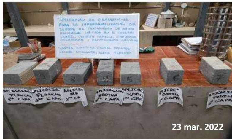
*Nota:* Esta figura muestra los testigos con las diferentes capas y métodos de aplicación.
