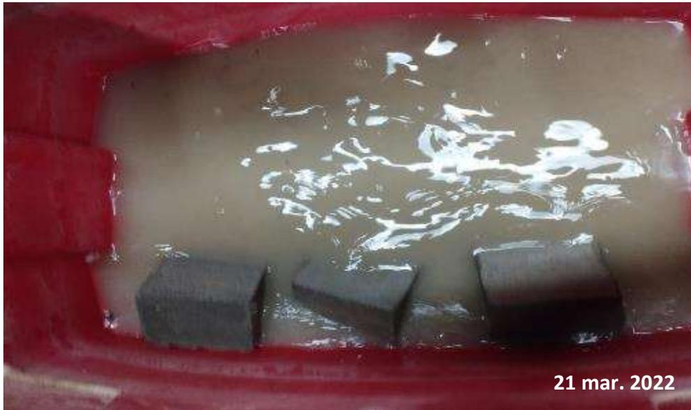
*Nota:* Esta figura exhibe los testigos sumergidos en agua para luego ser sometidos al ensayo de absorción.
