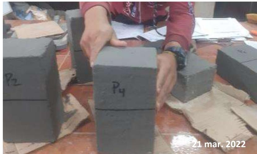
*Nota:* Esta figura muestra los testigos fisurados con una amoladora con una abertura de fisuración de 4 mm.
