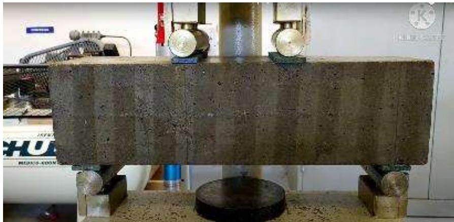
*Nota:* Esta figura muestra el equipo durante el ensayo de resistencia a flexión.
