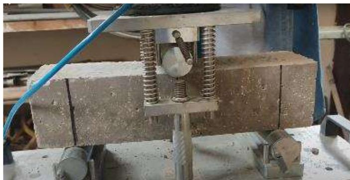
*Nota:* Esta figura exhibe el equipo durante el ensayo de resistencia a tracción.
