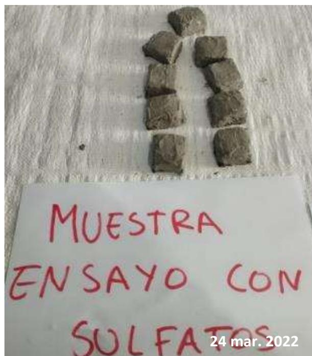
*Nota:* Se muestran los morteros revestidos con Sikalastic – 1K para realizar los ensayos de resistencia.
