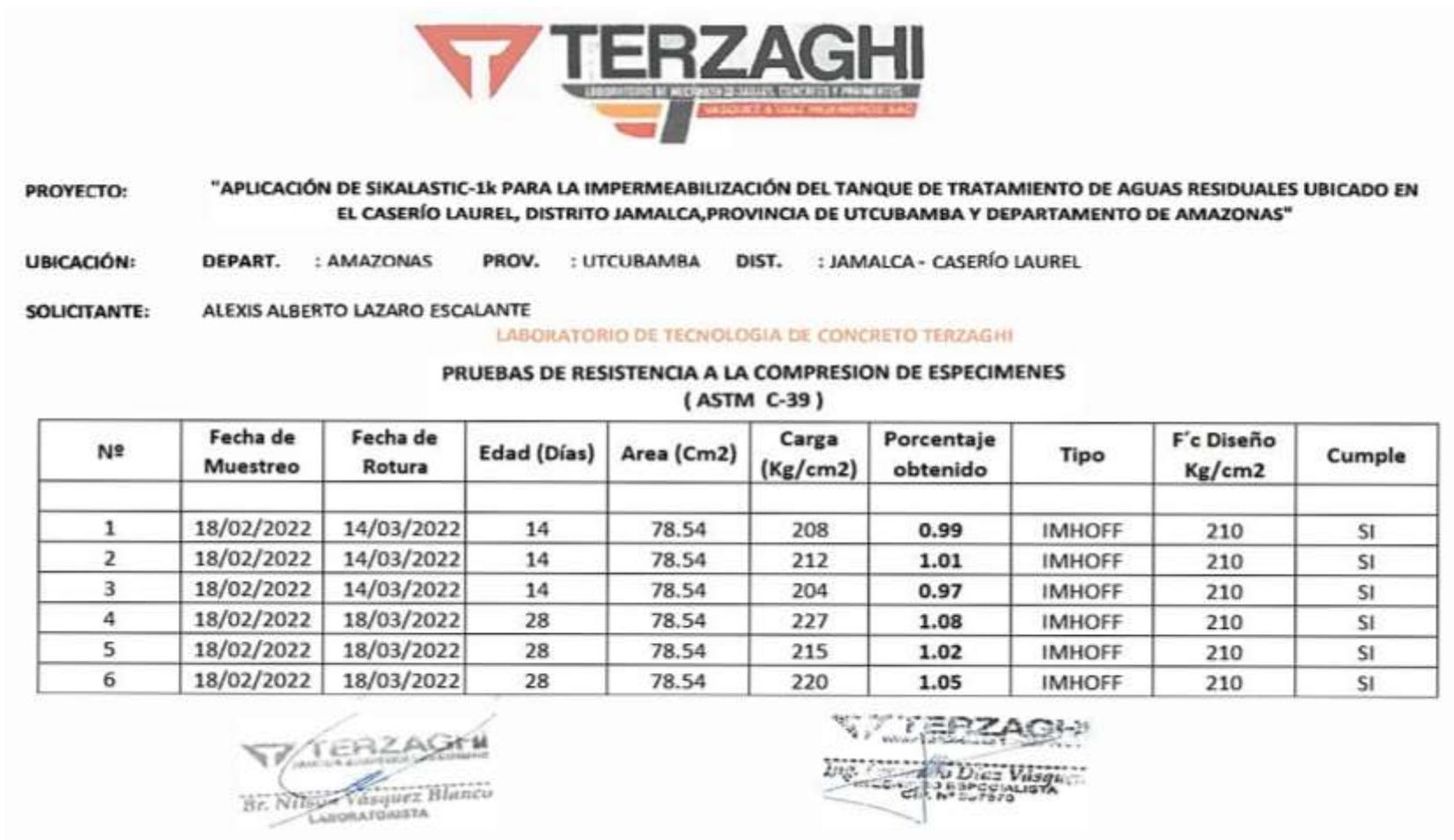
*Nota:* Se observan los resultados del ensayo a compresión.
