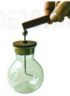
El electroscopio está formado por dos hojas metálicas colocadas en el extremo de una barra metálica y protegidas por un frasco. Al cargarse con cargas del mismo tipo, las dos hojas se repelen.
