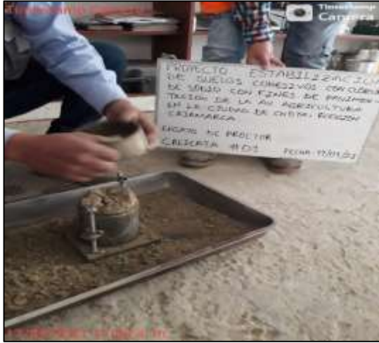
Retiro del cabezal del disco, molde para el ensayo, diámetro de 4", peso 3893gr, volumen 943cm 3 , en la C – 05
