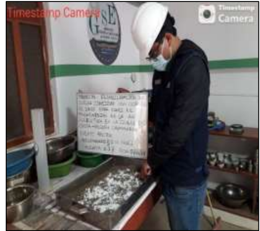
Mezcla de la muestra con el cloruro de sodio al 7% respecto al eso la muestra , para el CBR (6kg), en la C – 07.
