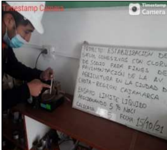
Ensayo de límite líquido mediante copa de Casagrande, adicionando el 5% del NaCl sobre la muestra C – 05.
