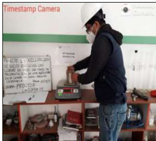
Posteriormente se pesa el material ya compactado en el molde con diámetro de 4", peso 3893gr, volumen 943cm 3 , en la C – 07.
