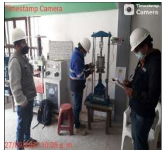
Ensayo de penetración – CBR, medición de las cargas aplicadas, en tiempos establecidos (0.30, 1.00, 1.30, 2.00, 2.30, 3.00, 4.00, 6.00, 8.00 y 10.00), en la C – 07.
