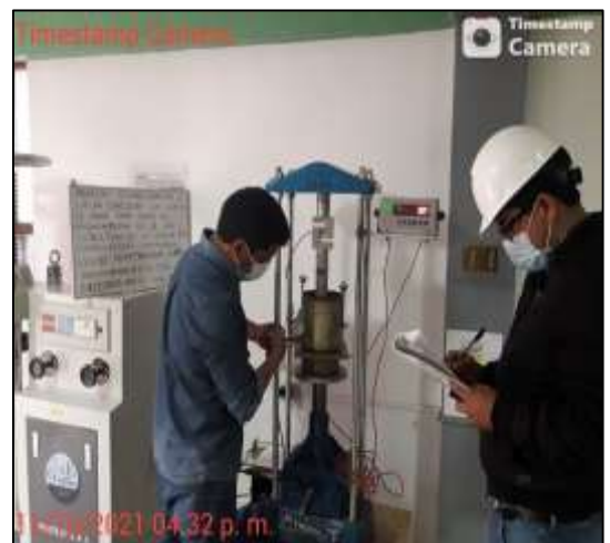
Ensayo de penetración – CBR, calibrando el manómetro y cronómetro para la medición de las cargas aplicadas, en tiempos establecidos (0.30, 1.00, 1.30, 2.00, 2.30, 3.00, 4.00, 6.00, 8.00 y 10.00) al 7% del cloruro de sodio respecto al peso de la muestra (6kg) en la C – 06.
