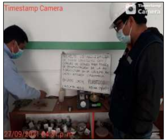
Se hacen bastones de 3 mm de diámetro, a través de una muestra que se frota con el vidrio en contacto, ensayo de límite plástico, en la C - 07.
