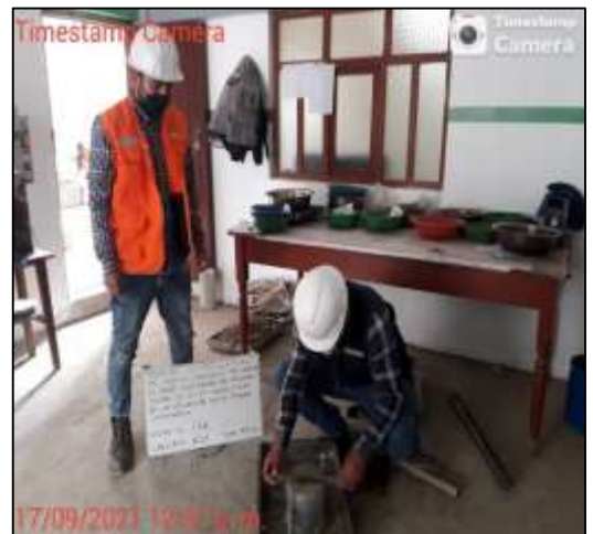
Retiramos el disco de la parte superior y pasamos una regla de metal por la superficie para enrasarlo hasta que esté al nivel del molde, en
