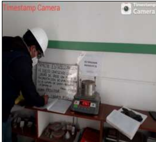
Peso del molde de 6" con la muestra compactada en la balanza, en la C – 04.
