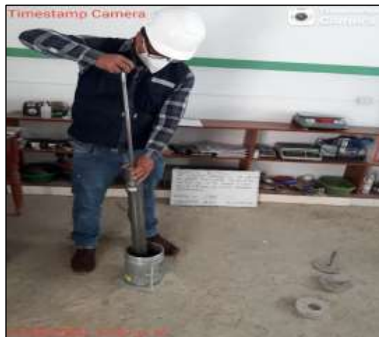
Compactación con uso del pisón de 40 lbf, se dan 56 golpes (repetir 5 veces), en la C – 04.
