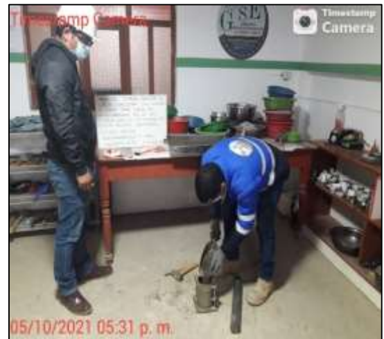
Colocación de la muestra en el molde, de manera intercalada en 3 capas, al 3% del NaCl respecto al peso de la muestra (3kg), C – 02
