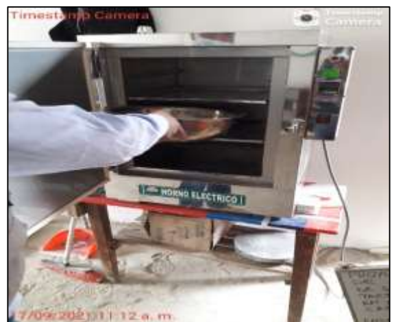
Colocación de la muestra C-01 en el horno, con temperatura de 110 \pm 5^{\circ}\text{C} durante 24 hrs.
