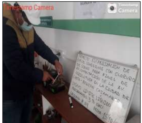
Ensayo de límite líquido mediante copa de Casagrande, adicionando el 3% del NaCl sobre la muestra C – 03.
