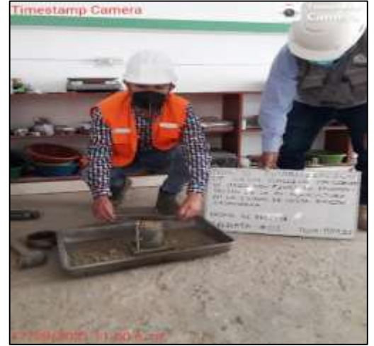
Pasamos una regla de metal por la superficie hasta que quede al ras, en la C – 06.
