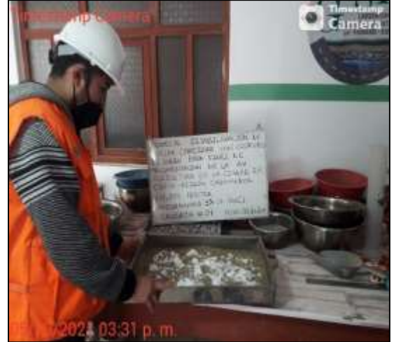
Colocación del cloruro de sodio al 7% respecto al peso de la muestra patrón (3kg) C – 07.
