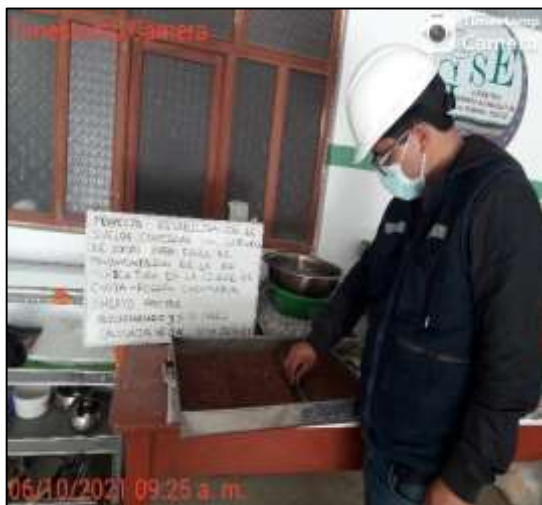
Separación de la muestra en tres partes para realizar el ensayo de Proctor al 3% respecto al peso de la muestra C - 04
