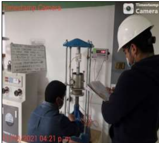
Ensayo de penetración – CBR, calibrando del manómetro y cronometro para la medición de las cargas aplicadas, en tiempos establecidos (0.30, 1.00, 1.30, 2.00, 2.30, 3.00, 4.00, 6.00, 8.00 y 10.00) al 5% del cloruro de sodio respecto al peso de la muestra (6kg) en la C - 01.
