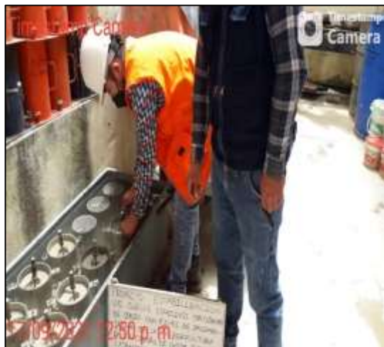
Colocación del molde CBR de 6" en agua para tomar la presión cada 24hr durante 4 días, en la C – 06.
