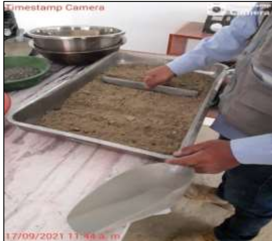
Separación del material en 3 capas, para el Proctor modificado (3 kg), en la C – 01.
