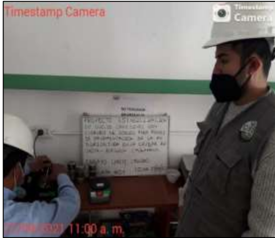
Uso de la copa de Casagrande por medio del conteo de golpes, ensayo de límite líquido C – 04.
