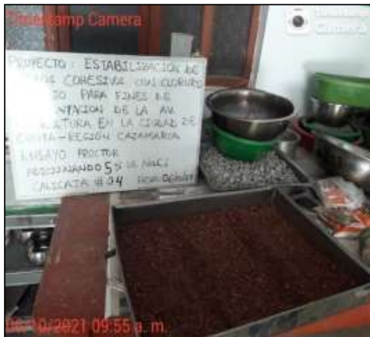
Se procede a partir en 3 partes para luego colocarlas intercaladamente en el molde, incorporando el cloruro de sodio al 5% del peso de la muestra (3kg), C – 04.
