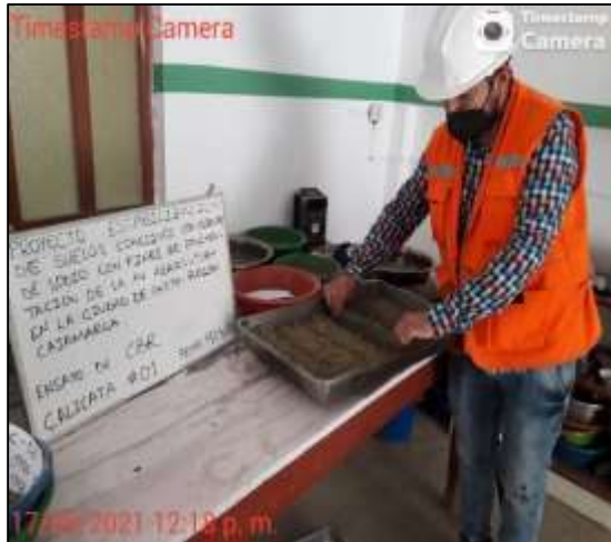
Partición de la muestra en 5 partes para luego colocarlas intercaladamente en el molde CBR de 6" (6 kg), en la C – 02.
