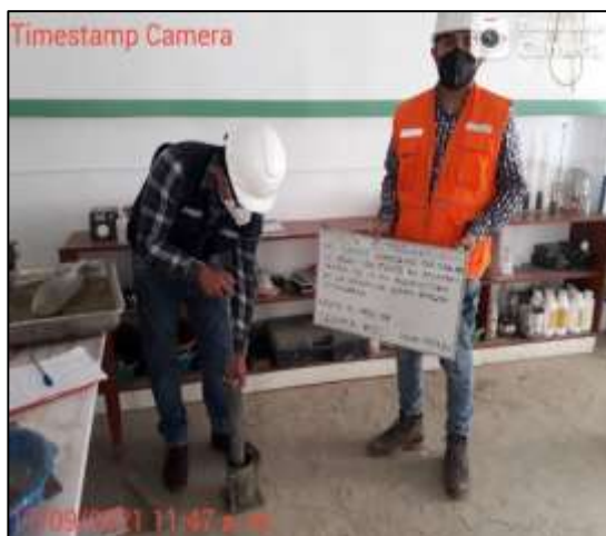
Compactación de la primera capa, se dan 25 golpes usando el pisón de 10 lbf (repetir 3 veces).
