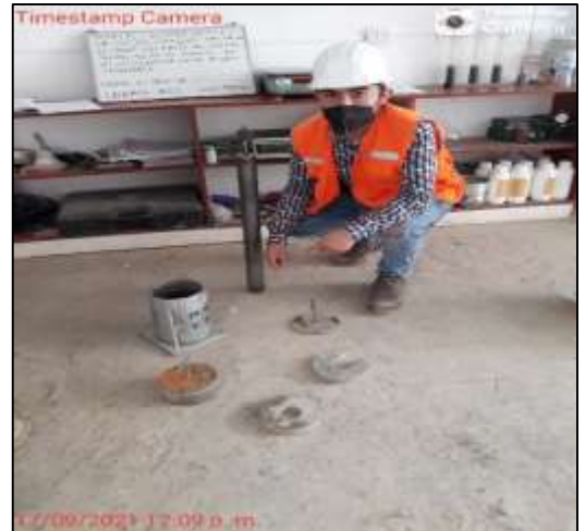
Equipos a utilizar en el ensayo CBR, el molde 6" (6 kg), el vástago, collarín, pesas, espaciador, en la C – 03.
