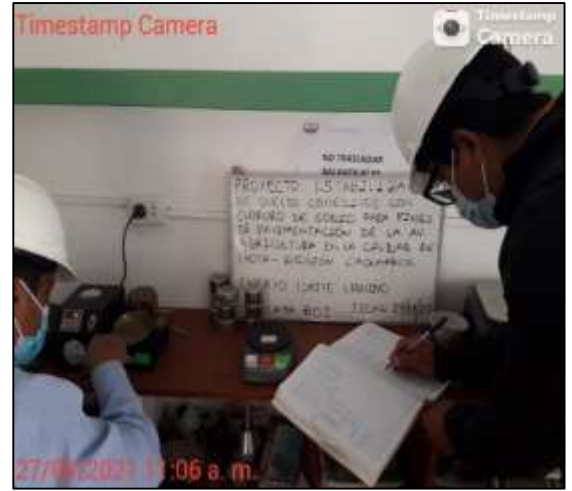
Uso de la copa de Casagrande por medio del conteo de golpes, ensayo de límite líquido C – 06.
