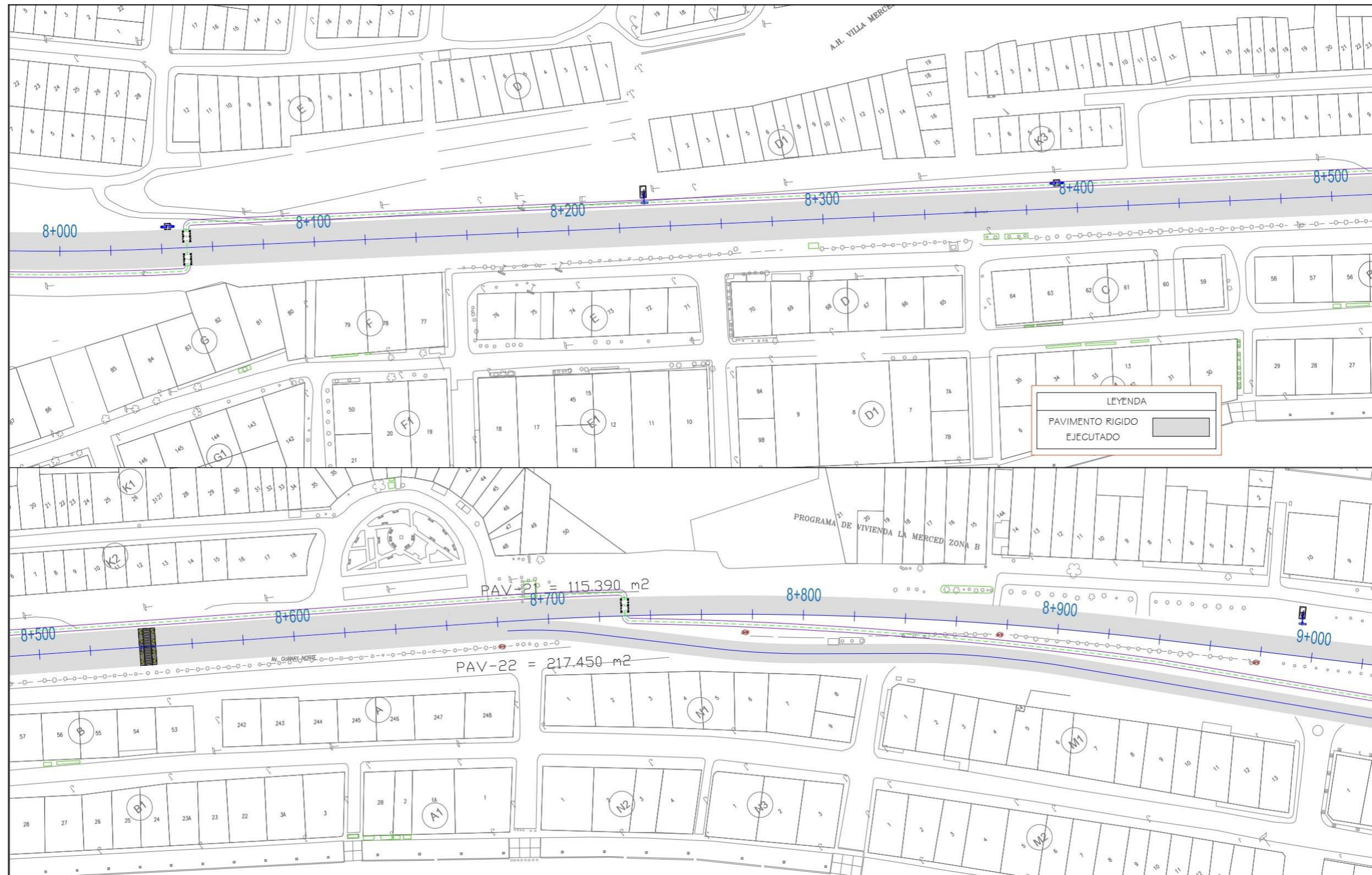
Plano 09. Constructivo Pavimento Rígido Km 8+000 – Km 9+000
