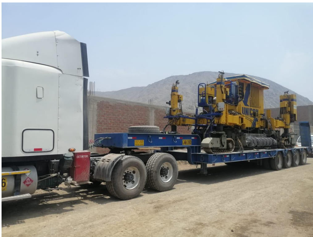
Fotografía 01. Llegada de Pavimentadora de Encofrado Deslizante Wirtgen SP500
