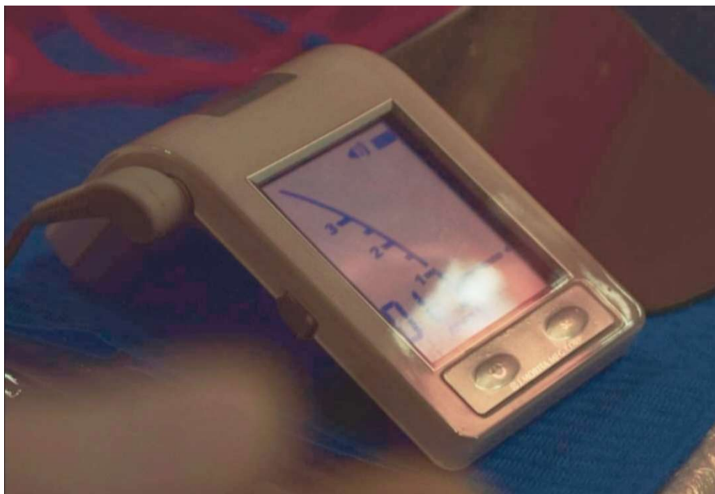
Foto N°10: Medición de la longitud de conducto con Root Zx Mini Morita
