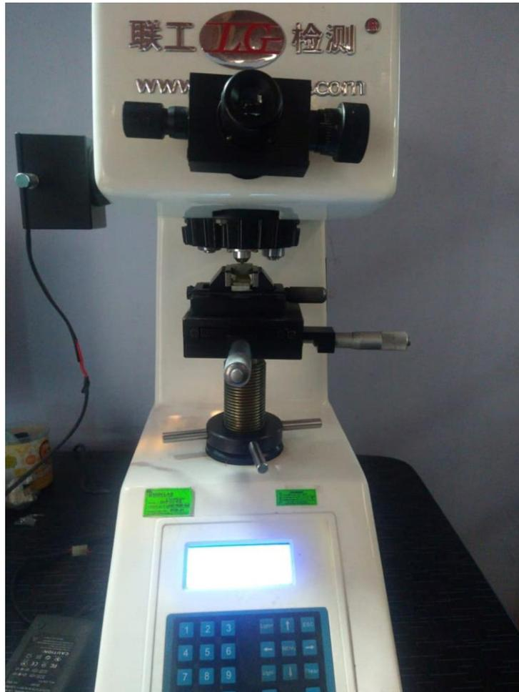
**Figura N°4** Microdurómetro Vickers
