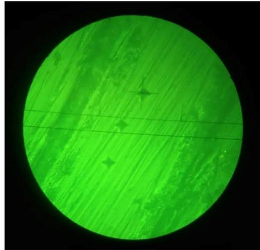
**Figura N°7** Indentación final visto desde el lente óptico del Microdurómetro de Vickers.
