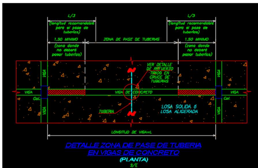
**Figura 103.** Detalle de Refuerzo de pase de tubería en vigas de concreto.
