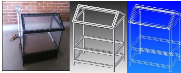
Figura 24: Invernadero utilizado para las pruebas de la estación de monitoreo.
