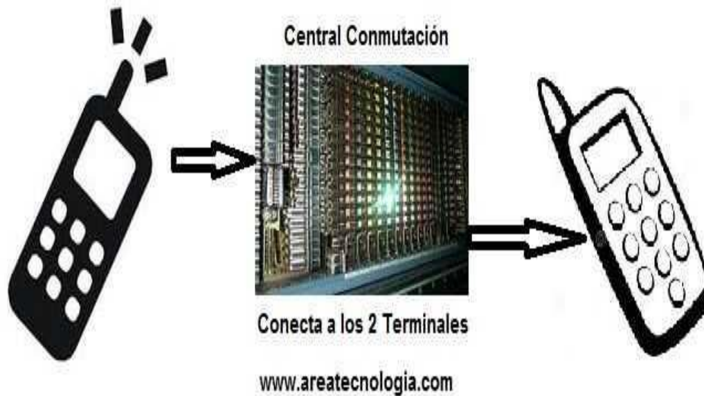
Figura 4. Central de Conmutación telefónica
