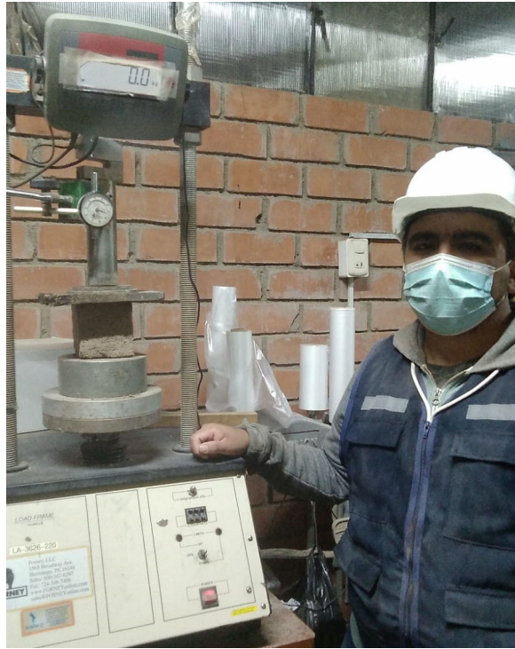
Figura 47: Muestra de adobe en la máquina de compresión biaxial Elaborado por: el autor
