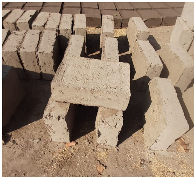
Figura 7: Bloque de adobe estabilizado
