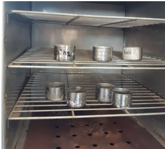
Figura 27: Colocación de muestras de ensayo en horno
