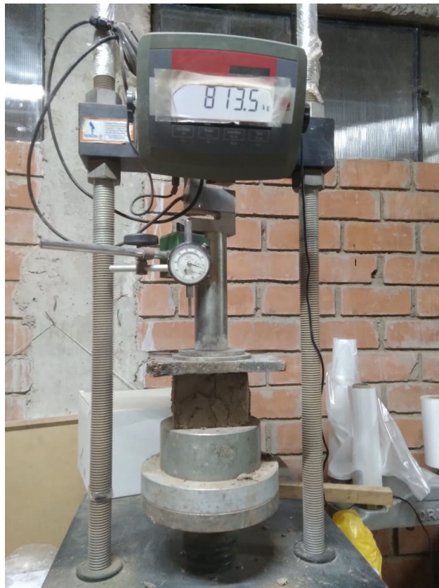
Figura 48: Cubo de adobe en la máquina de compresión Elaborado por: el autor
