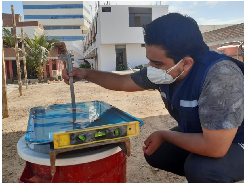
Figura 49: Medición del nivel de agua para ensayo
