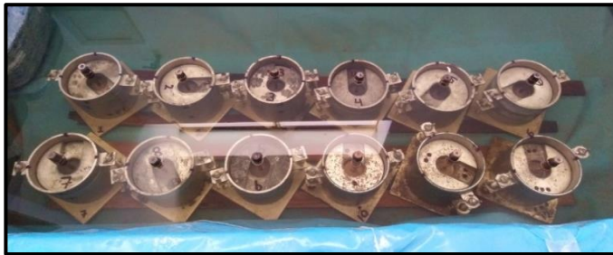
e) Se colocó el disco espaciador y la pesa correspondiente dentro del molde con el material compactado, para después saturarlo durante 96 horas
