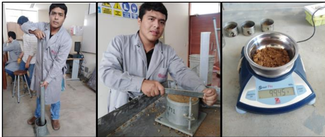
(d) Compactado del material
