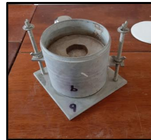
f) Finalmente se procedió a la penetración, registrado los datos correspondientes, y determinación de la densidad
