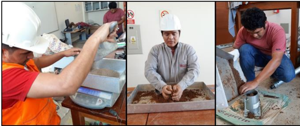
(a) Pesado de la muestra, después del tamizado
