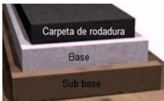
Figura 3. Estructuración de un piso
