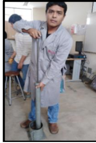
c) Compactado de la muestra en 5 capas con 12,25 y 56 golpes
