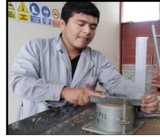
d) Enrasado del material, para después determinar su densidad
