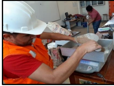
a) Pesado de la muestra preparada para después sacar su contenido de humedad
