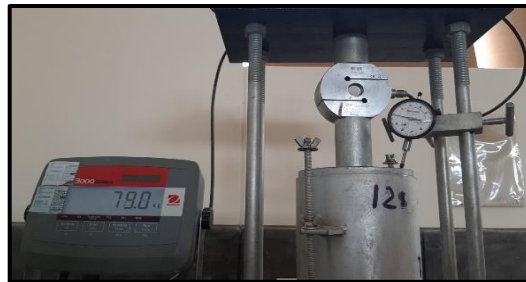
f) Finalmente se procedió a la penetración, registrado los datos correspondientes, y determinación de la densidad
