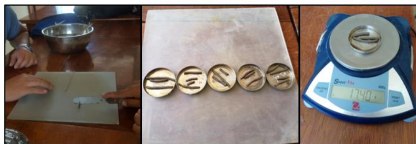
(b) Determinado de contenido de humedad
