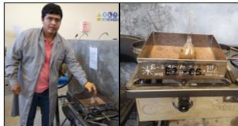
(c) Eliminación del aire atrapado, por calentado
