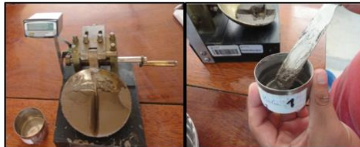
(e) Toma de la muestra en la parte de cierre, para el contenido de humedad
