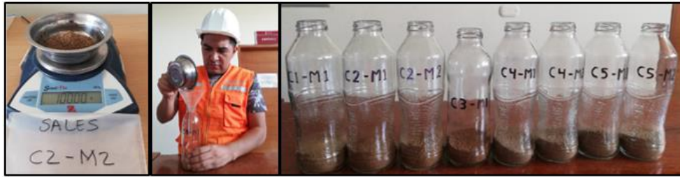
(a) Saturación de 100 gr de muestra en 300 ml de agua destilada
