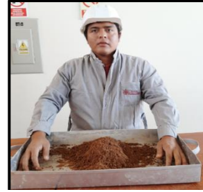
b) Mezclado de agua por agregar con la muestra
