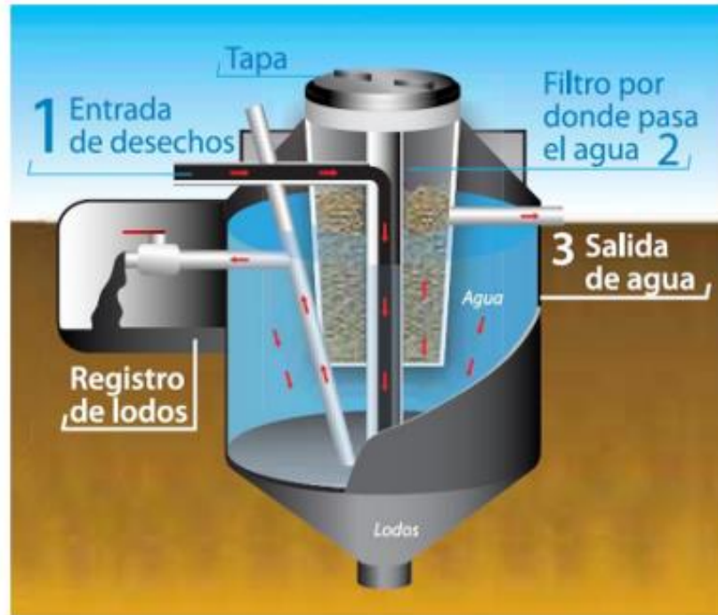
Figura 18. Operación del biodigestor
