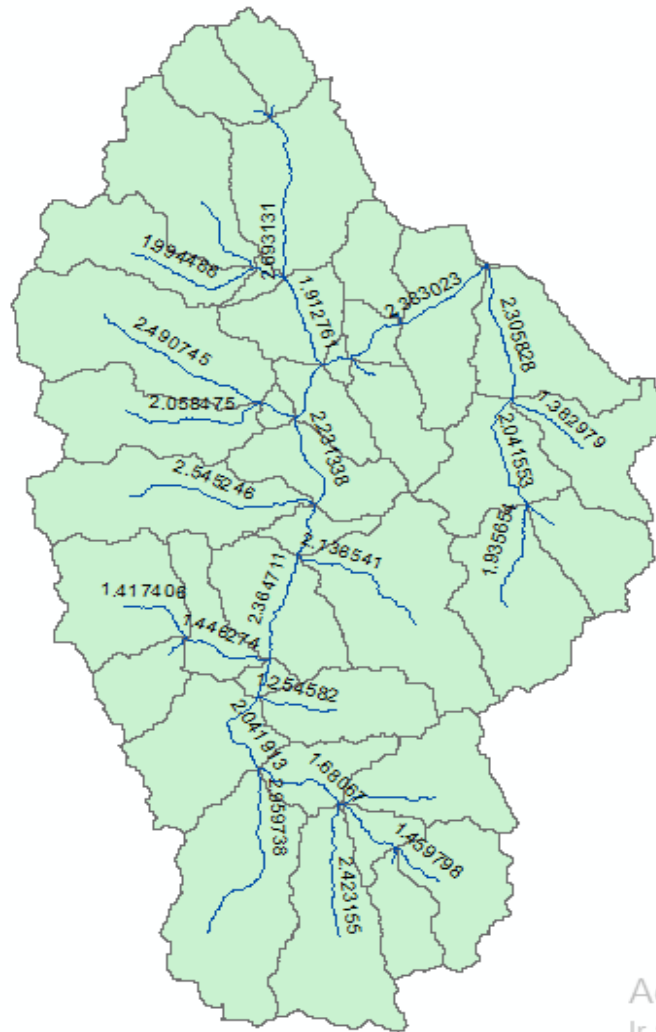
Figura 83. Gráfica del tiempo de concentración en las subcuencas del río Mosna Fuente: Elaborado por los autores
