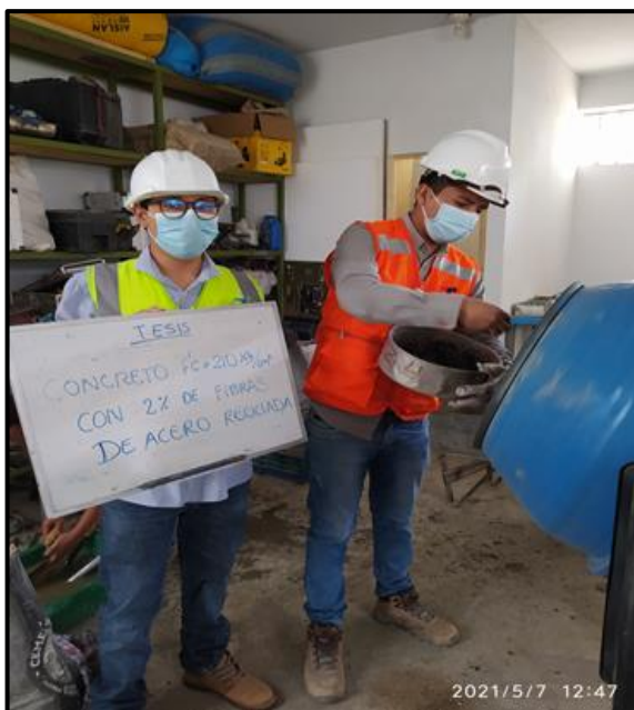
Figura 52 Elaboración del concreto con 2% de fibras de acero recicladas
