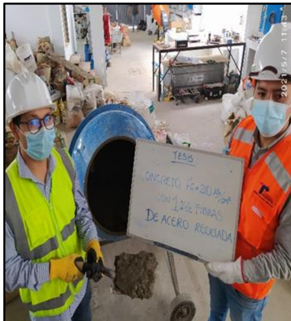
Figura 50 Elaboración del concreto con refuerzo del 1% de fibras recicladas
