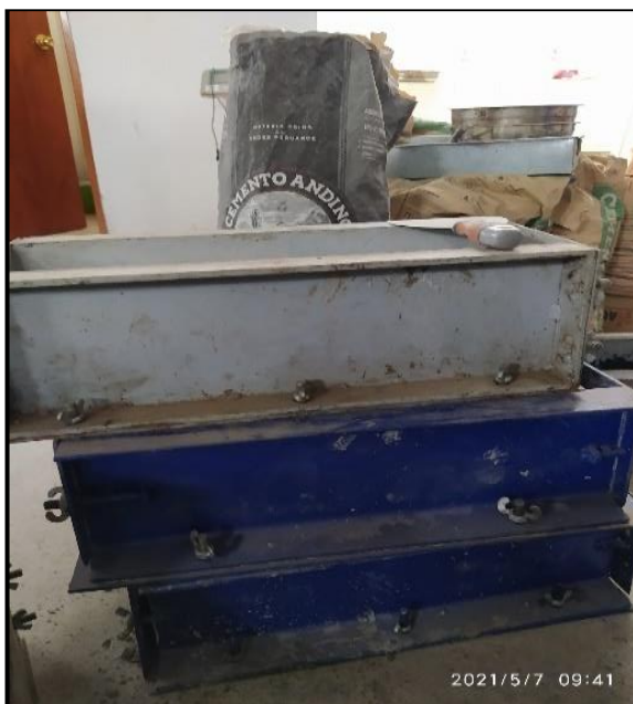
Figura 43 Molde de viga prismática
