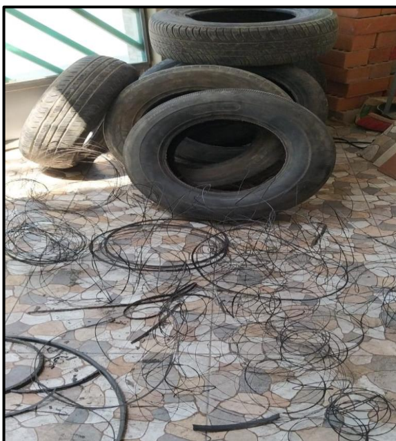
Figura 25 Extracción de las fibras de acero recicladas
