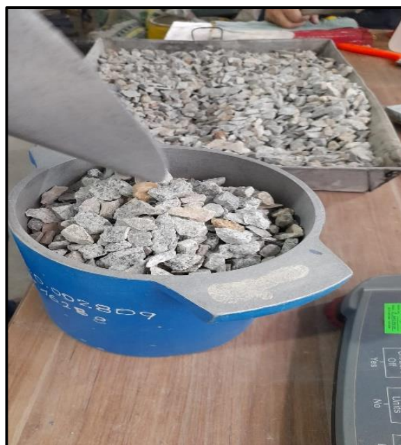
Figura 41 Molde de volumen de 0.002809 m 3 con agregado grueso
