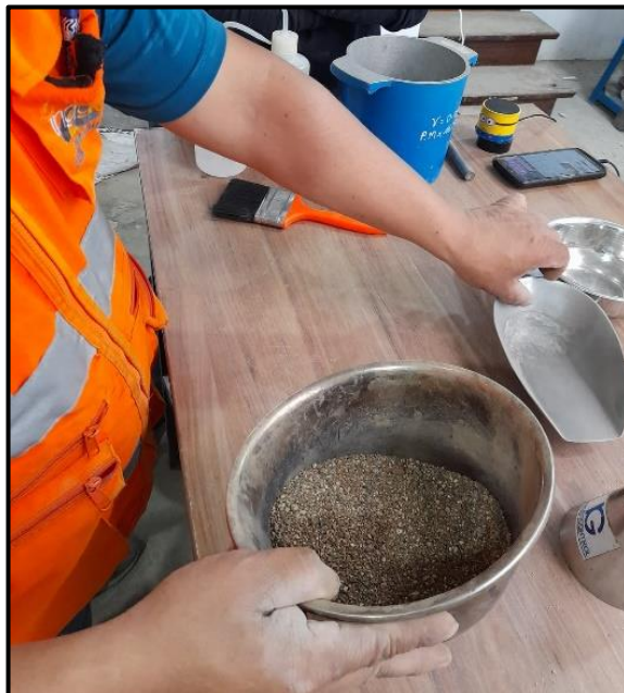
Figura 36 Agregado fino superficialmente seco
