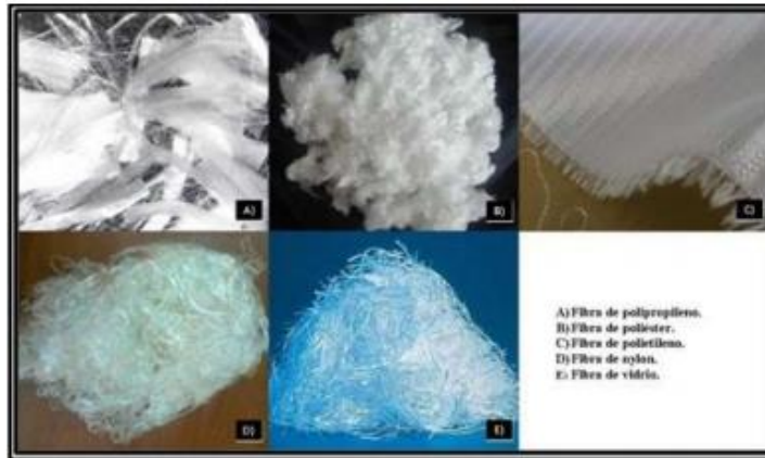
Figura 2-11. Tipos de fibras sintéticas utilizadas para el refuerzo de materiales
