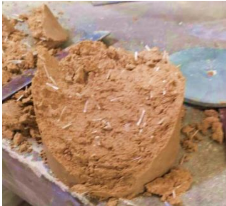
Figura 4-3. Muestra de proctor con adición de fibras al 1% y cemento portland al 3%
