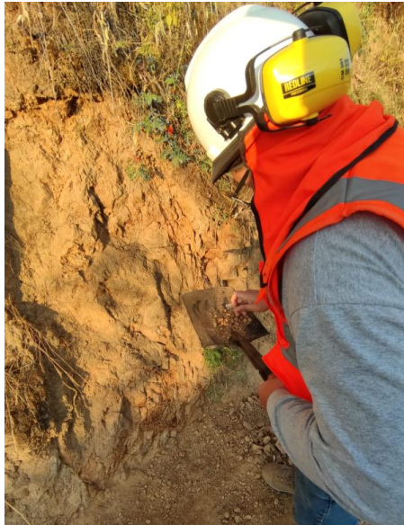
Figura 3-5. Extracción de la muestra de suelo
