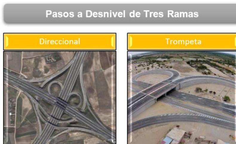
Figura 9. Tipos de Intersección a Desnivel de Tres Ramas.
