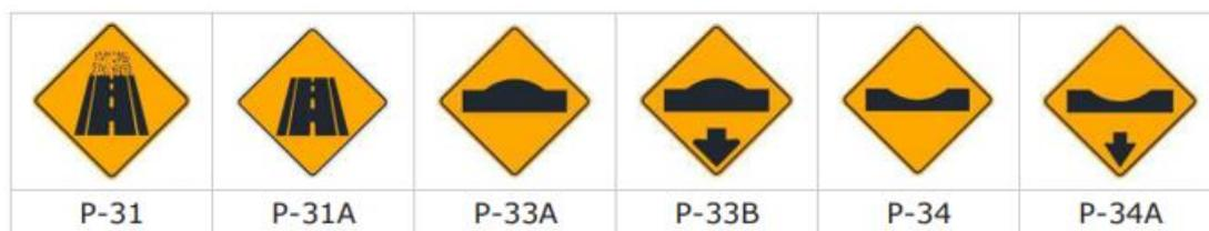
Figura 23. Señales de Prevención con Características en la Superficie de Rodadura.
