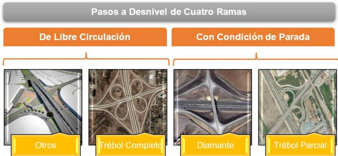
Figura 8. Tipos de Intersección a Desnivel de Cuatro Ramas.
