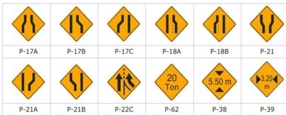
Figura 24. Señales de Prevención por Restricciones de la Vía.
