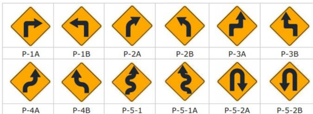
Figura 22 Señales de Prevención con Curvatura Horizontal.
