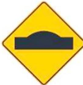
*Figura 59. Símbolo P-33A Señal Proximidad Reductor de Velocidad Tipo Resalto*
