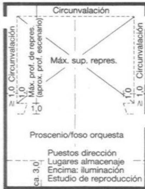
Figura 149. **Gran escenario de ensayo. Planta tipo**
