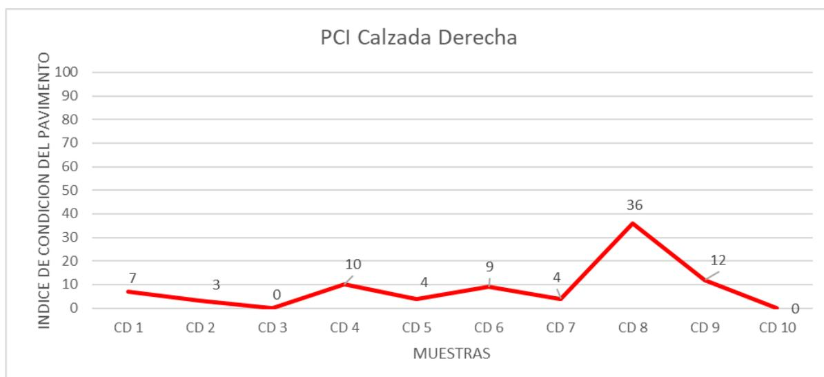
Figura 21. Gráfica de datos obtenidos (PCI) para la calzada derecha.
