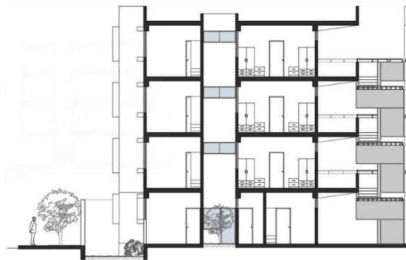
Figura 78: Corte bloque habitaciones Fuente: Elaboración propia
