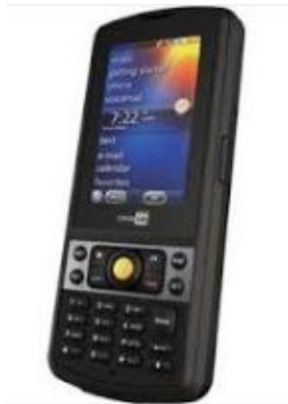
Figura 50: Lector de código de barras Cipherlab
