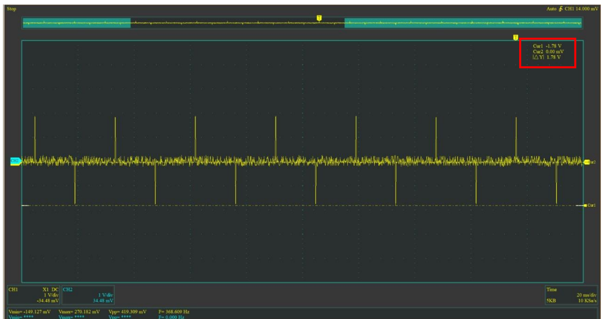
Figura 101: Resultado obtenido de la sub etapa acopladora y amplificadora para la señal negativa.
