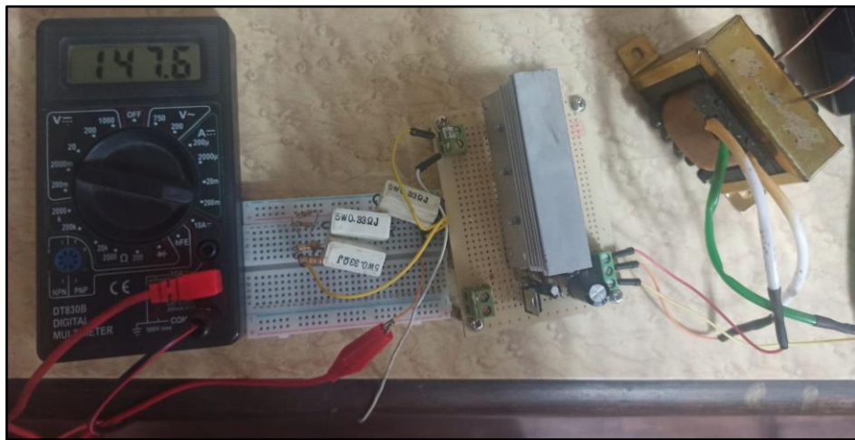
Figura 104: Prueba de limitación de corriente.
