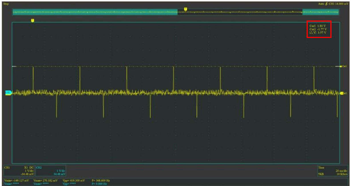
Figura 100: Resultado obtenido de la sub etapa acopladora y amplificadora para la señal positiva.
