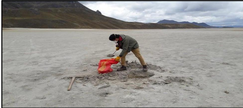
**Figura 31:** Extracción de la muestra de relave In Situ
