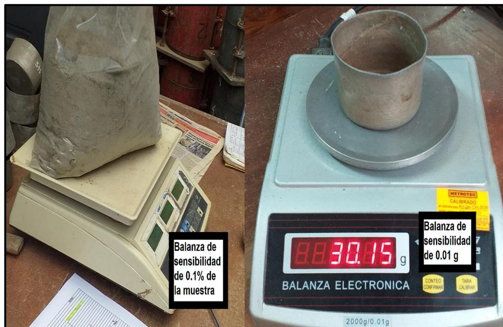
**Figura 16:** Balanzas de 0.1% y 0.01 g de sensibilidad usadas en los ensayos de suelos
