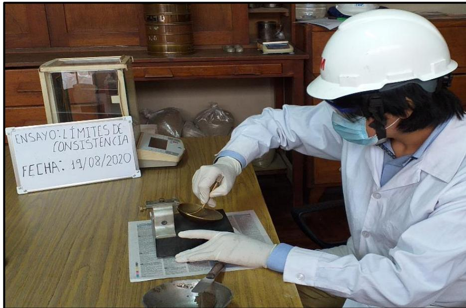
**Figura 46:** Elaboración del ensayo límite líquido
