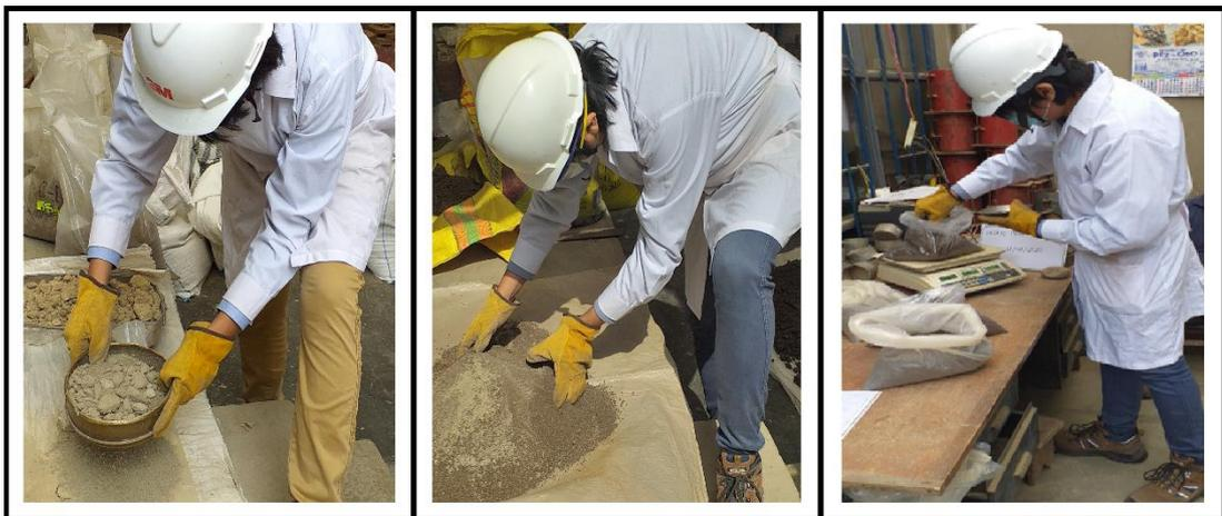
**Figura 52:** Tamizado del relave, mesclado de relave + suelo y pesado de muestras (2500 gr)
