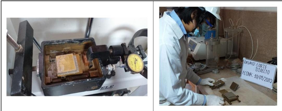
**Figura 59:** Extracción del espécimen de la máquina de corte
