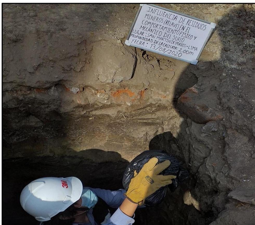
**Figura 39:** Extracción de la muestra
