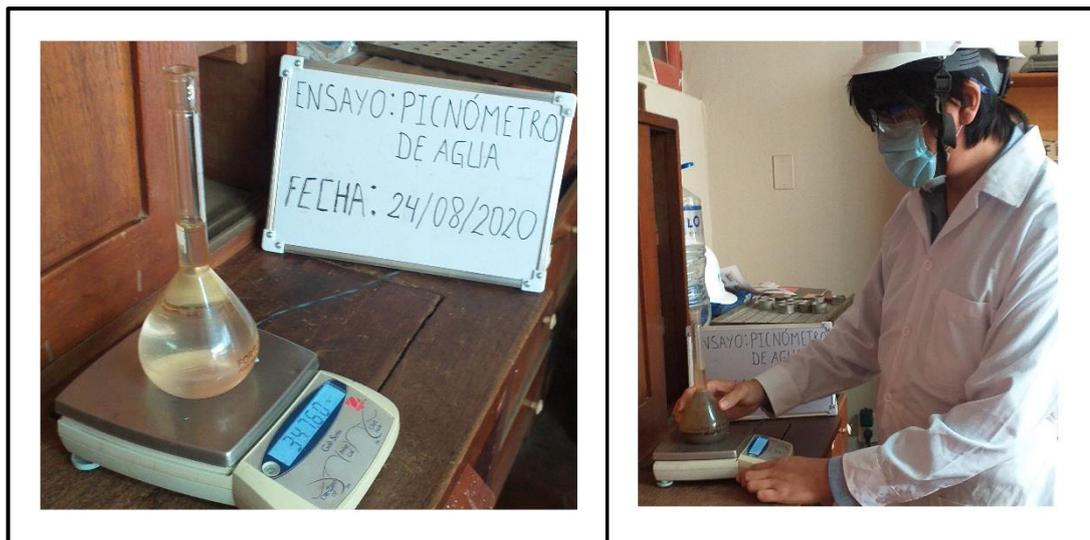
**Figura 71:** Pesado de picnómetro + agua, pesado del picnómetro + agua + muestra
