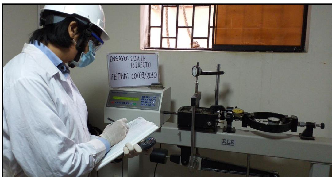
**Figura 58:** Anotación de la deformación unitaria y el esfuerzo cortante del suelo 80% + relave 20%
