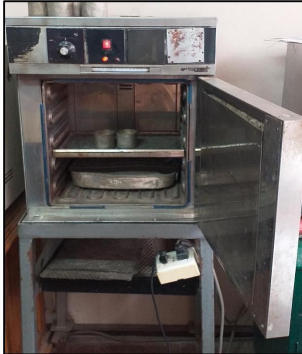
**Figura 17:** Horno para el secado de muestras
