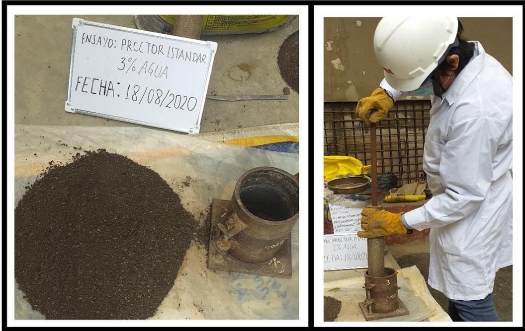
**Figura 53:** Muestra humedecida, compactación de la muestra
