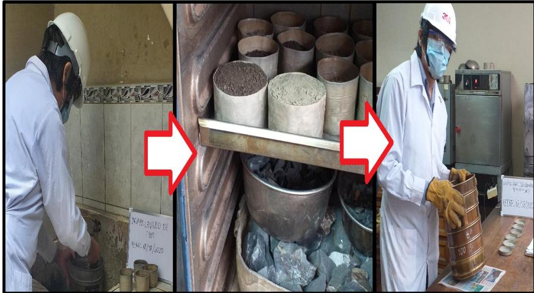
**Figura 42:** Lavado, secado y tamizado de muestras
