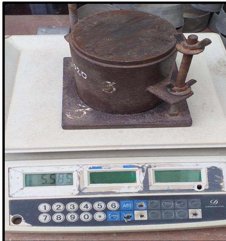
**Figura 54:** Pesado del molde proctor con la muestra compactada: suelo 80% + relave 20%
