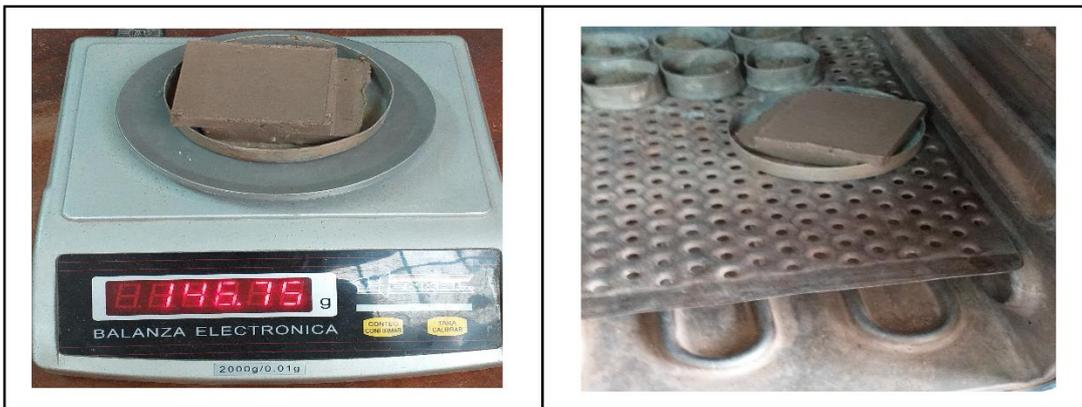
**Figura 60:** Pesado del espécimen húmedo y secado del espécimen
