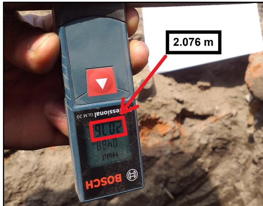
**Figura 38:** Medición con distanciómetro laser
