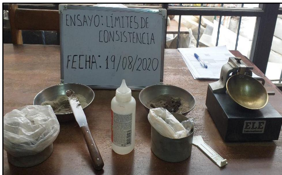
**Figura 45:** Materiales para el ensayo de límites de Atterberg
