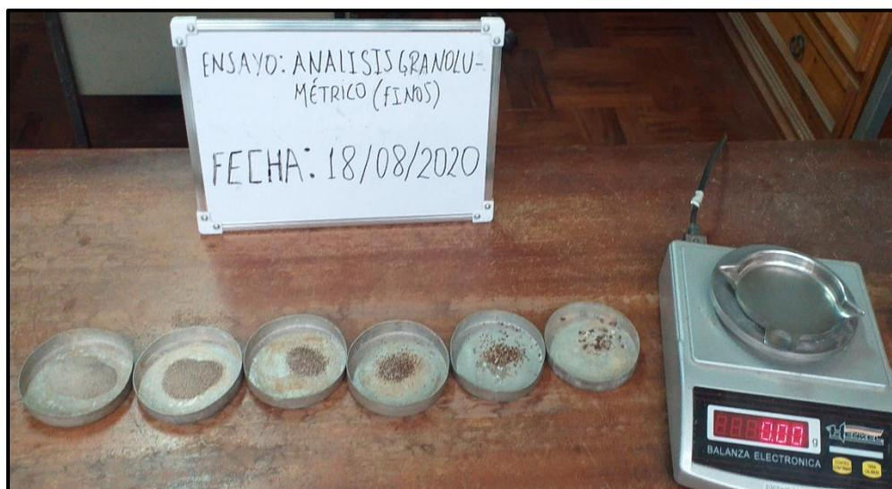
**Figura 43:** Muestra tamizada y separada en taras
