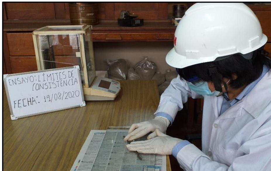
**Figura 47:** Elaboración del ensayo límite plástico
