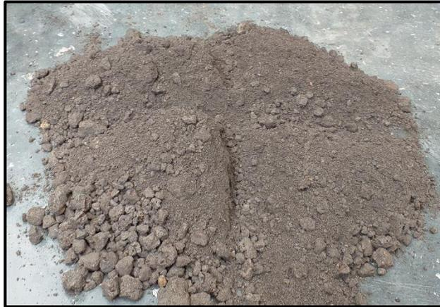
**Figura 41:** Cuarteo del suelo alterado
