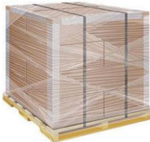
Figura 21. Palatización con Stretch Film
