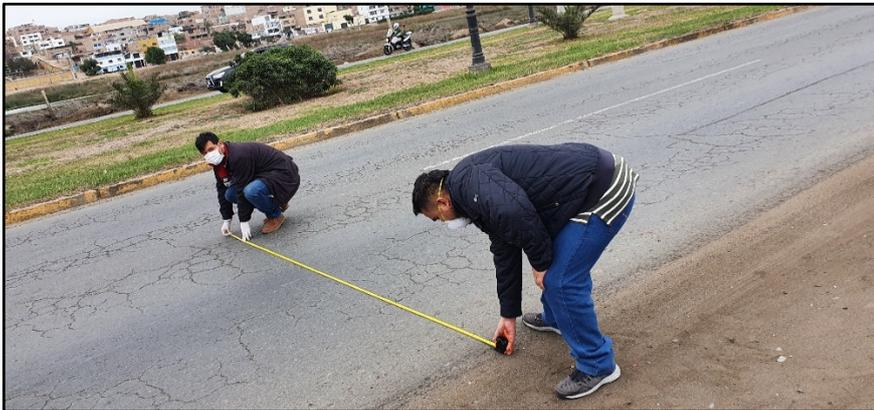
**Figura 63:** Medición del carril derecho
