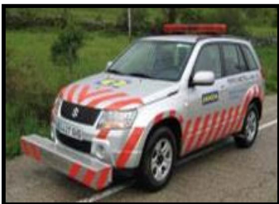
**Figura 18:** Perfilómetro Laser RSP
