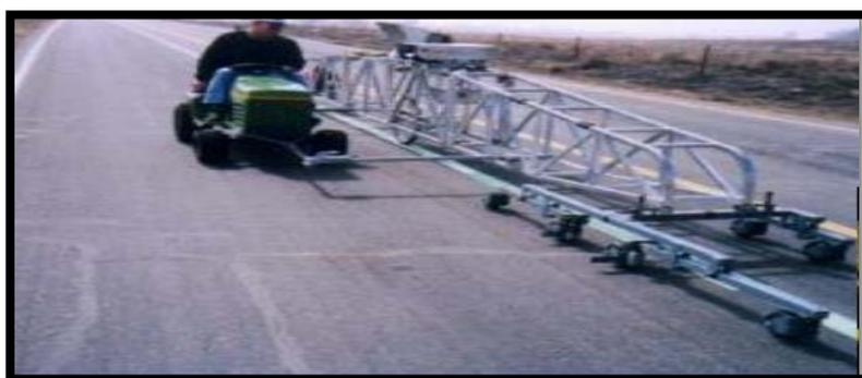
**Figura 20:** Perfilógrafo California
