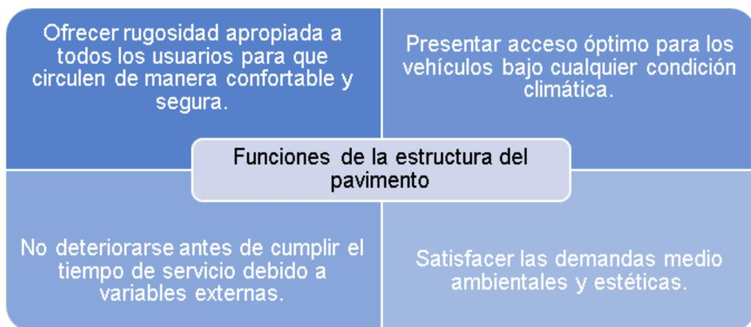
**Figura 3:** Principales funciones que cumple la estructura del pavimento
