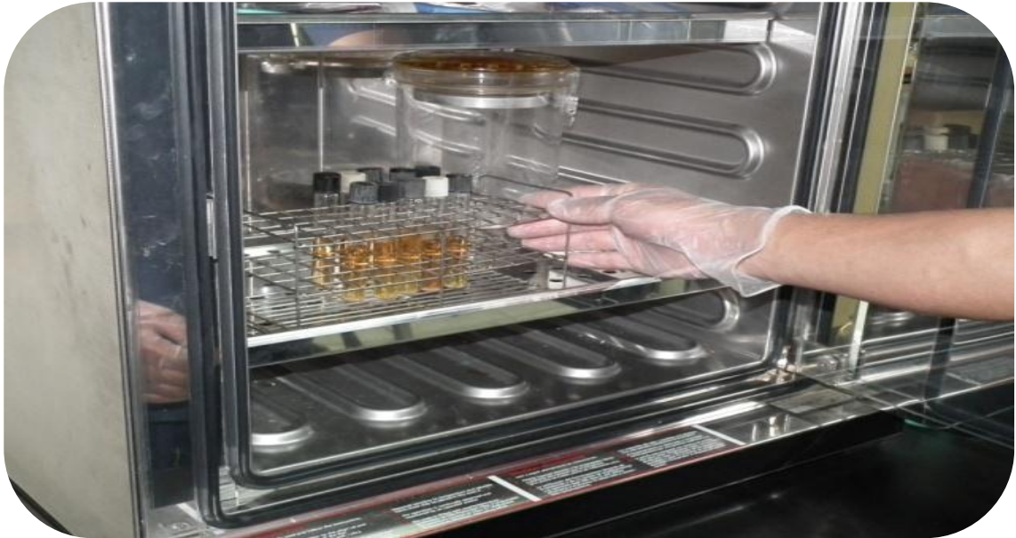
Figura 12: Colocación de los tubos de vidrio tapa rosca con la muestra en la estufa
