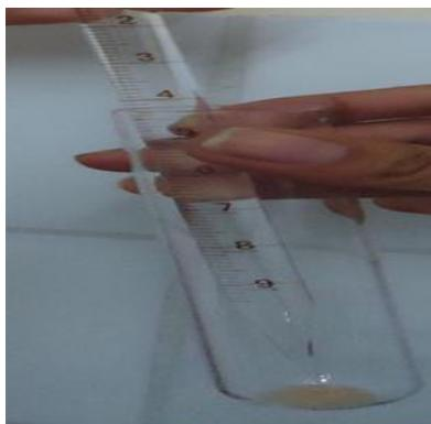
FOTO 11: extracto obtenido después de 5 min de la aplicación de metanol
