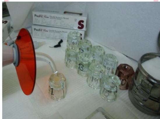
FOTO 18: aplicación de la glicerina gel en la superficie de la resina
