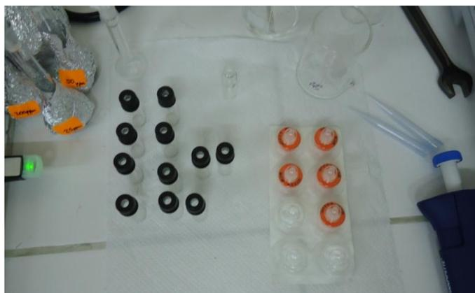
FOTO 14: proceso de filtrado del extracto y llenado al vial.
