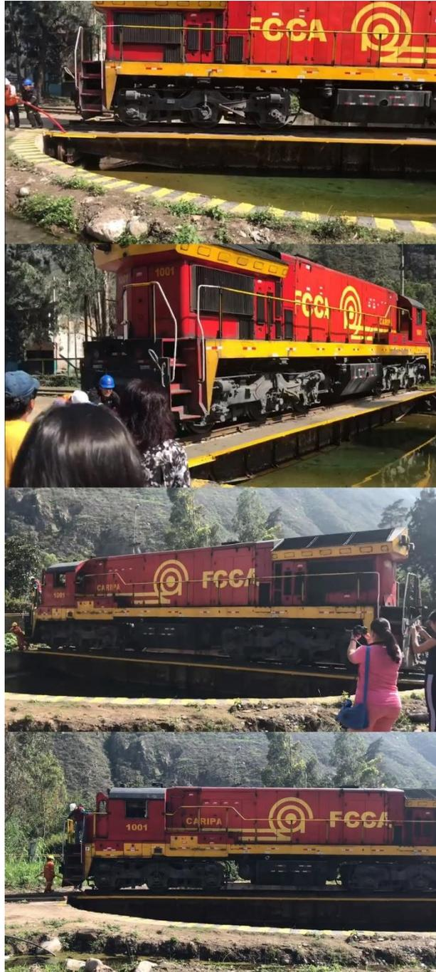
**Figura 10** Secuencia del giro de la locomotora en la tornamesa, en la Estación de San Bartolomé.
