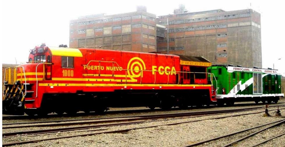
**Figura 3 Primera locomotora del Ferrocarril Central Andino propulsada a gas.**
