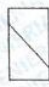
Tipo 4 Fractura diagonal sin fisuras a través de los extremos, golpe suave con un martillo para distinguirla del Tipo 1
