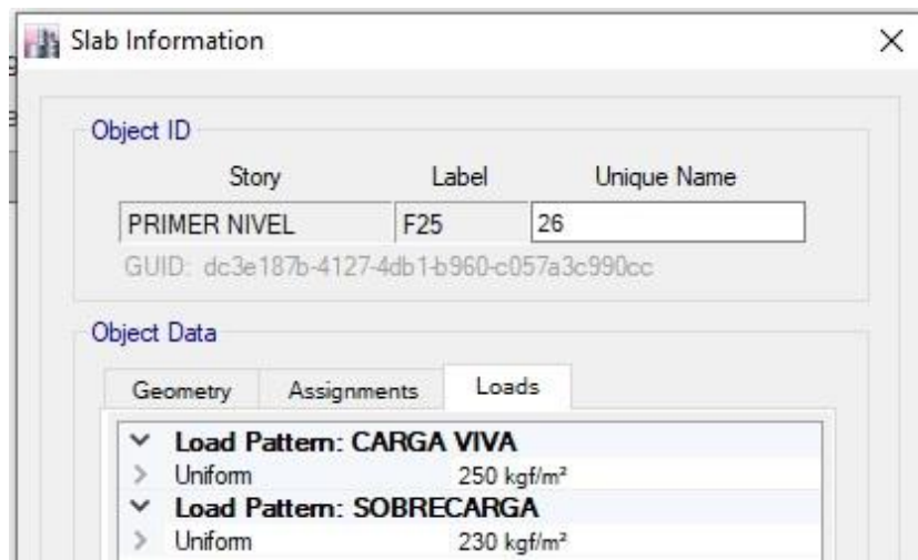
Figura 51. Cargas del primer al tercer nivel Fuente: ETABS
