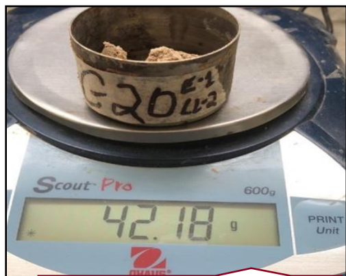
Recipiente con muestra tras estar 24 horas en el horno a 110 \pm 5 °C.
