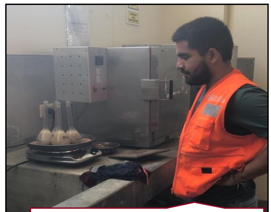
Cocina eléctrica con 4 picnómetros llegando al punto de ebullición.
