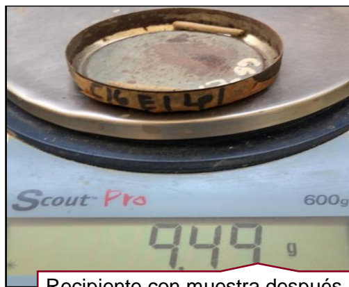
Recipiente con muestra después de permanecer 24 horas a 110 \pm 5^\circ\text{C}
