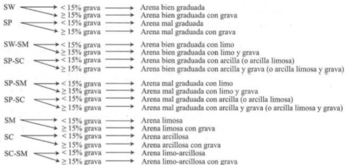
Figura 27. Diagrama de flujo para nombre de grupo de suelos arenosos. Fuente: Braja, 2015, p. 85
