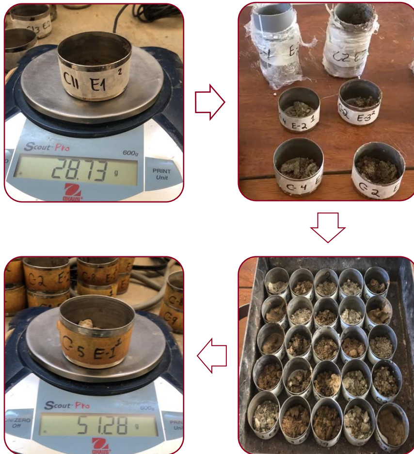
Figura 21. Procedimiento de Ensayo de Contenido de Humedad. Fuente: Elaborado por los autores
