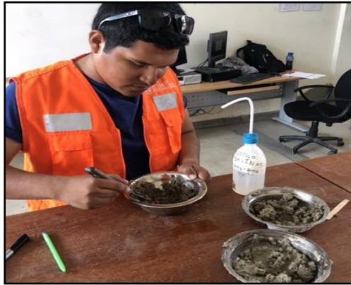
Masa de textura homogénea obtenida de la muestra y agua destilada.
