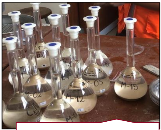
Picnómetros con muestra puestos a enfriar para el día siguiente.
