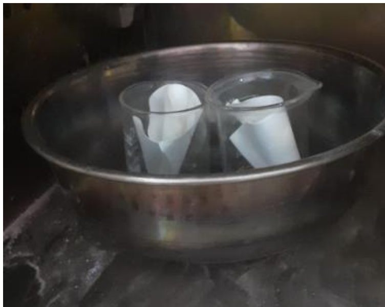
Figura 31. Carbonización del papel filtro y su contenido en un beaker. Fuente: Elaborado por los autores
