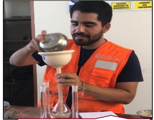
Muestra vertida en picnómetro con ayuda de un embudo.
