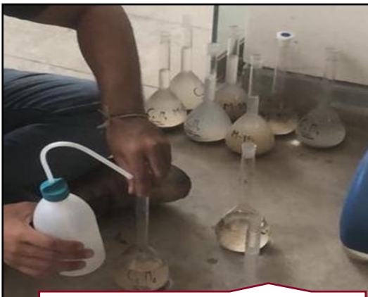
Vertido de agua destilada en picnómetro con ayuda de una piseta.
