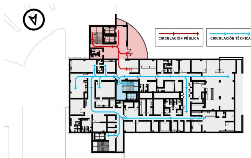
Figura N°46.- Circulaciones Hospital "JAMO" – 3° Nivel
