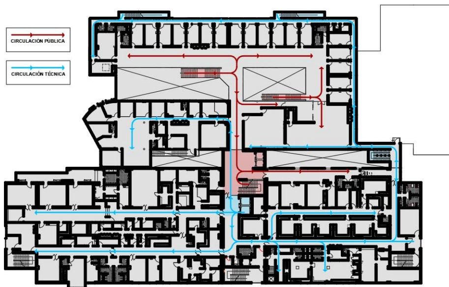
Figura N°29.- Circulaciones pública y técnica – 2° Nivel
