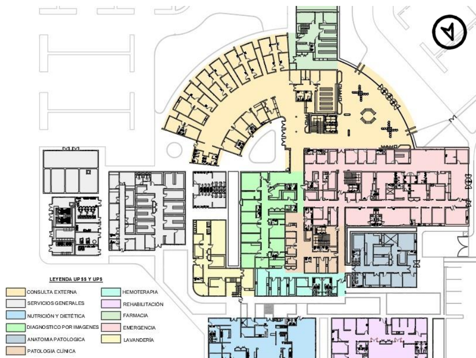
Figura N°35.- Zonificación Hospital "JAMO" – Primer Nivel
