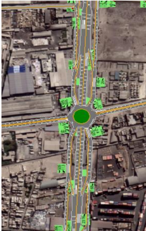
Figura 94: Diseño de la propuesta trébol rotatorio en Av. Néstor Gambetta con Av. Carlos Izaguirre en Synchro 10.0
