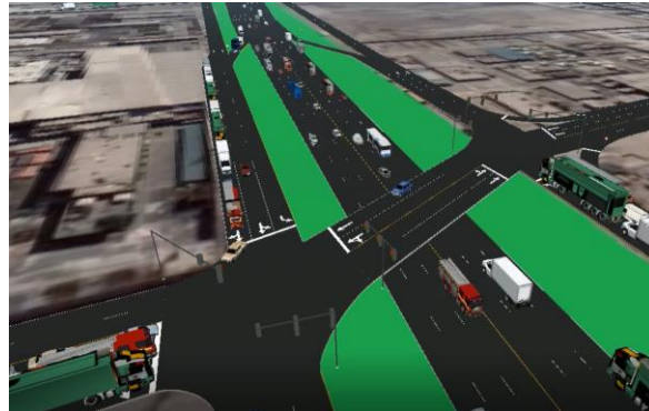
Figura 78. Simulación de la propuesta diamante tipo II. 3D Viewer.
