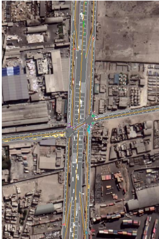
Figura 92. Simulación de propuesta diamante tipo III. Synchro 10.0 Elaboración: la autora
