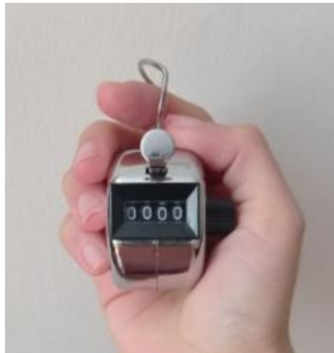
Figura 19: Contador Manual para Aforo Vehicular.
