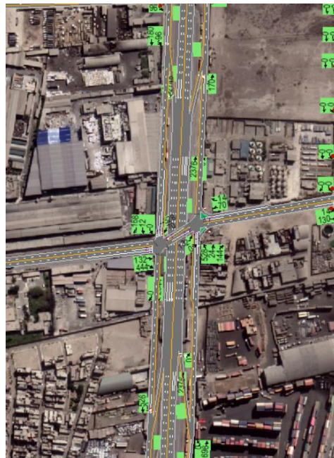
Figura 79: Diseño de la propuesta diamante tipo III en Av. Néstor Gambetta con Av. Carlos Izaguirre en Synchro 10.0
