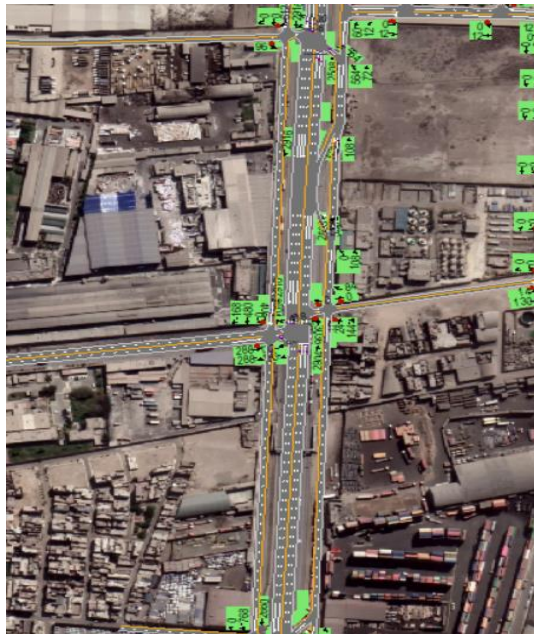
Figura 49: Diseño de la situación actual en Av. Néstor Gambetta con Av. Carlos Izaguirre en Synchro 10.0
