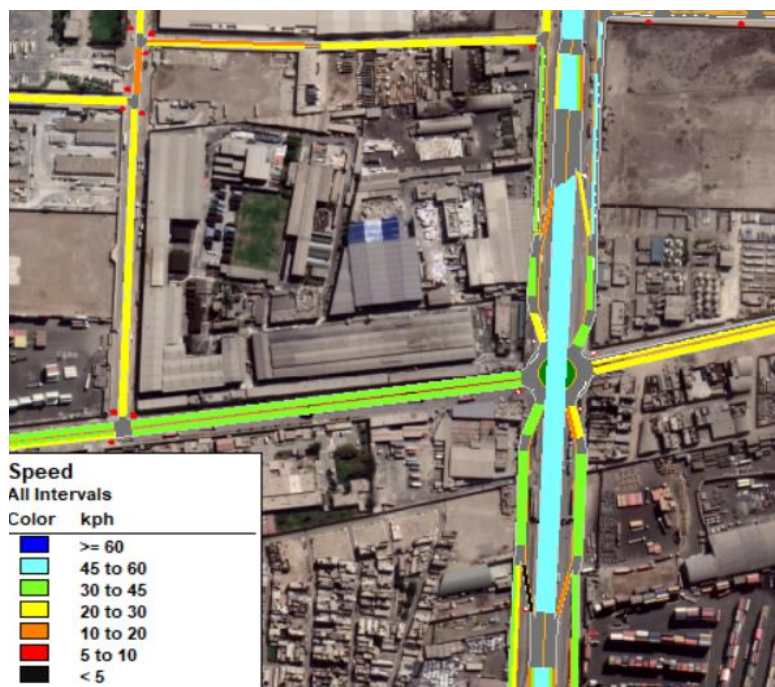
Figura 112: Velocidades según la propuesta intercambio vial a desnivel trébol rotatorio en los cruces Calle 6, Carlos Izaguirre y Calle Las Vegas.
