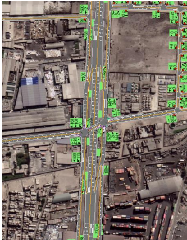
Figura 64: Diseño de la propuesta diamante tipo II en Av. Nestor Gambetta con Av. Carlos Izaguirre en Synchro 10.0
