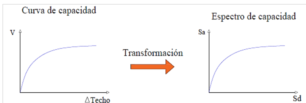
Figura 15. Transformación de la curva de capacidad al espectro de capacidad. Fuente: Adaptado de Fajardo, 2012
