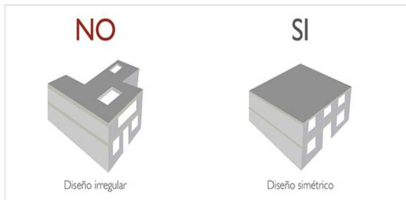
Figura 3 Diseño en una vivienda sismorresistente
