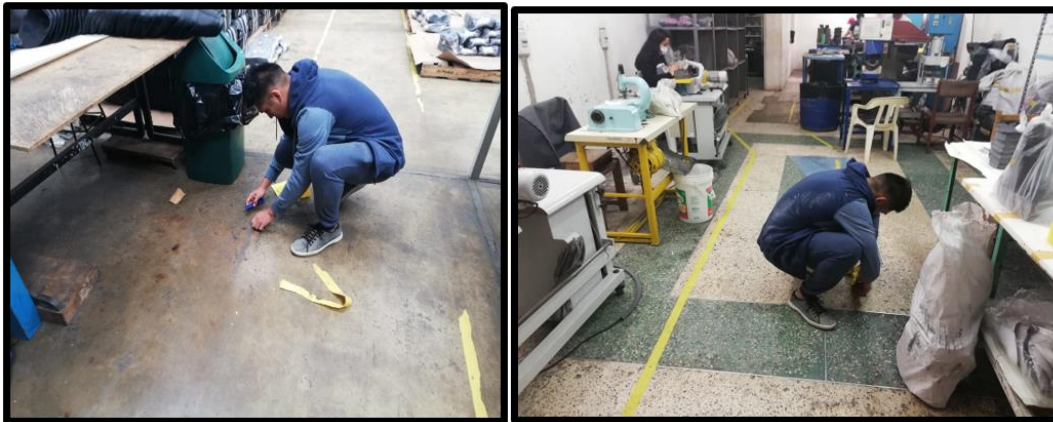
Figura 119. Señalización de cinta amarilla
